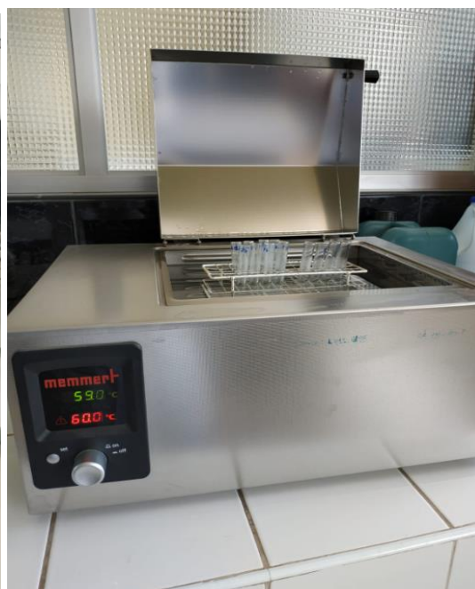
Anexo 26. Izquierda de preparación de solución buffer a pH 6,5 y 7,0 con pH metro y derecha equipo de baño de maría.
