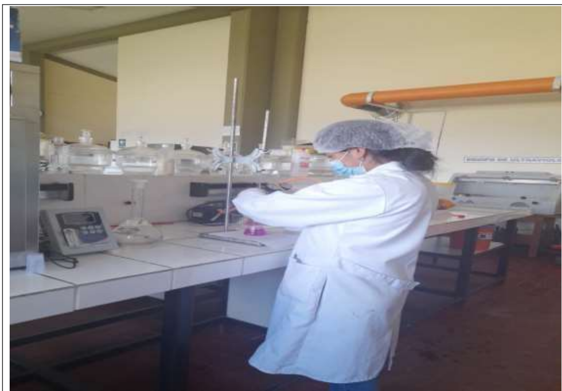
Imagen N°03 Estandarización de la solución NaOH 0.1N
