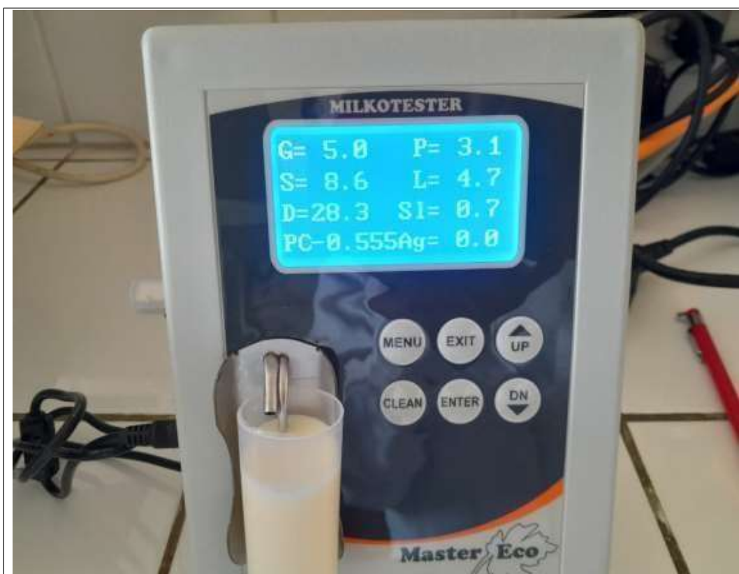
Imagen N°08 lectura espectroscopia ultrasónica.
