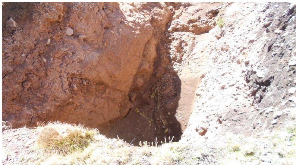
Figura Nº A.7 Características de suelo estratificado en condición apta para uso en el cuerpo de la presa
