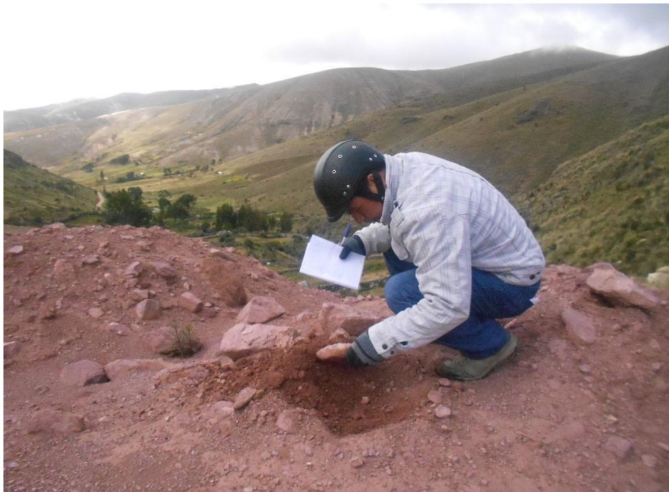
Figura A.4 Arcilla apto para uso del cuerpo de la presa trasladado desde la cantera Puca Puca
