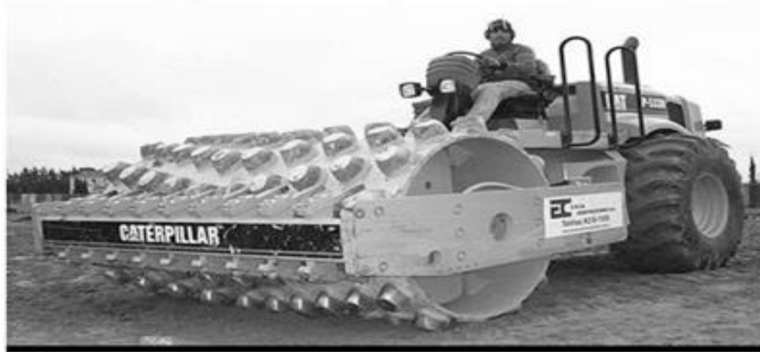
Figura Nº 1.24 Maquinaria rodillo pata de cabra Fuente: Obras civiles 2012
