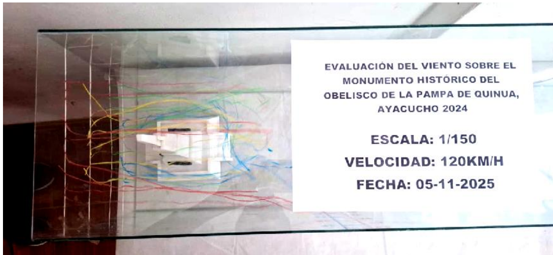
Figura 4.77: Experimento: Planta Líneas de corriente V=120km/h
