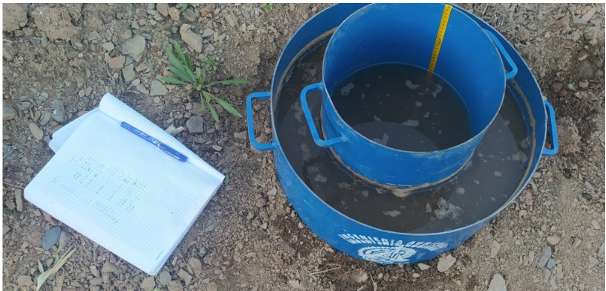
Figura 2.13: Prueba de infiltración
