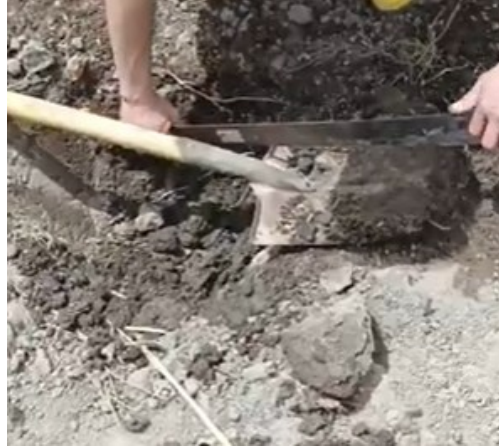
Figura 2.9: Extracción de porción del suelo
