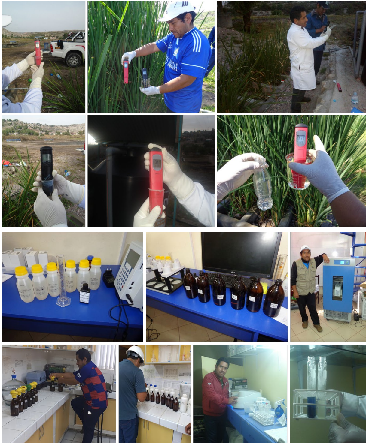
Fotografías N° 07. Trabajos de laboratorio para el análisis físico, químico bacteriológico. Los parámetros a evaluados con un Multiparámetro In Situ son la temperatura, pH, Conductividad eléctrica, y Sólidos totales disueltos (TDS); por otro lado, las muestras de 500 ml se llevan a los laboratorios de la Universidad Nacional de San Cristóbal de Huamanga – Facultad de Ciencias Biológicas y el PTAR “la Totorá” para su análisis correspondiente (DBO5, Coliformes fecales, fosfatos y nitratos), para ello se hacen uso de los equipos: Incubadora y sistema de medición de DBO5, Espectrofotómetro y botellas y diluciones.
