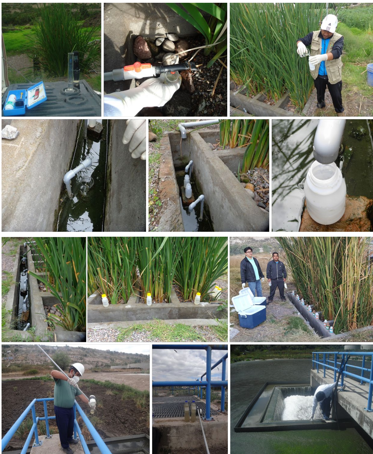
Fotografías N° 06. En la parte superior, trabajos de regulación y estandarización del caudal útil antes de su aforo en los Efluentes de los humedales con gravas de \varnothing 1/4", \varnothing 1/2", \varnothing 3/4"; Inferior se realizan los muestreos correspondientes del mes, tanto del Sedimentador Integrado N° 2 (Afluente), como de los HAFSSH (Efluentes). Luego las muestras, son transportados en un Cooler hacia los laboratorios para su análisis respectivo.
