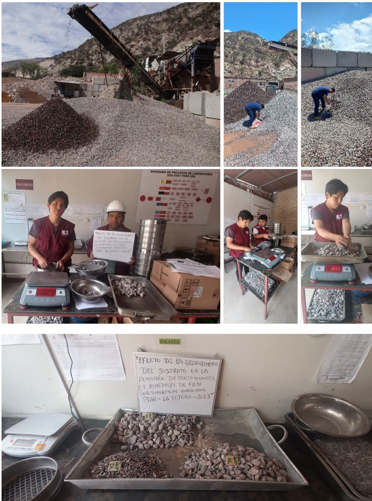
Fotografías N° 02. Ensayos de laboratorio Análisis Granulométrico de agregado grueso en gravas de \phi 1/4" , \phi 1/2" , \phi 3/4" , utilizado como sustrato.
