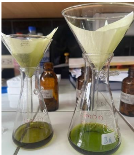
Figura 5. Filtración del extracto de cáscara de Citrus limon (L) Osbeck. "limón"
