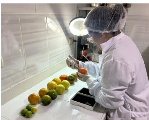
Figura 2. Determinación de la firmeza.
