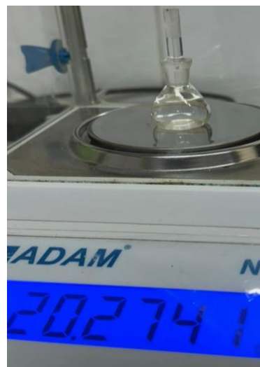
Figura 2. Pesaje del picnómetro con agua destilada para la calibración del equipo.
