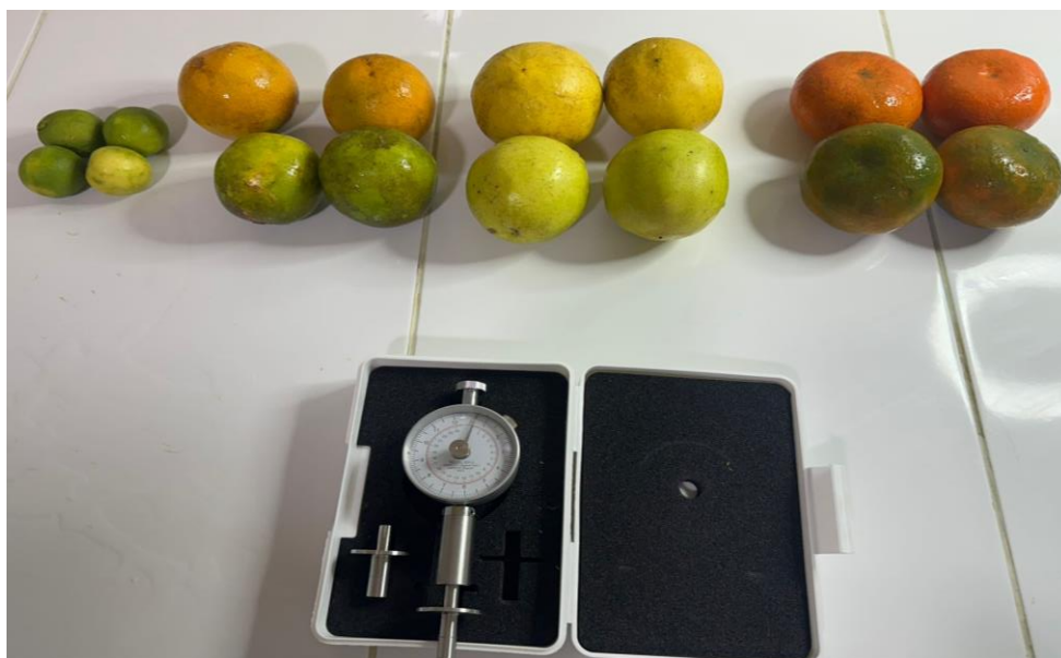
Figura 1. Muestra de Citrus limon (L.) Osbeck “limon”, Citrus aurantium L. “naranja”, Citrus limetta “lima” y Citrus reticulata “mandarina” con el equipo de medición de la firmeza denominado penetrómetro.
