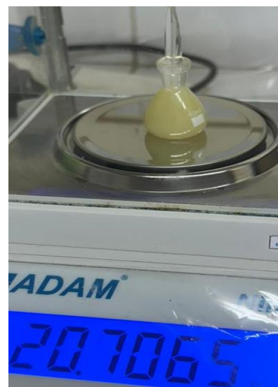
Figura 2. Pesaje del picnómetro con agua destilada para la calibración del equipo.
