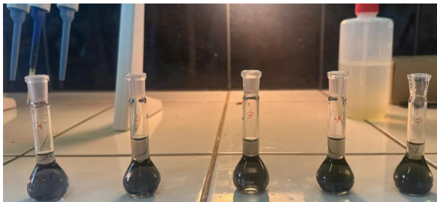
Figura 1. Preparación de diluciones para la solución estándar de ácido gálico por el método de Folin – Ciocalteu.
