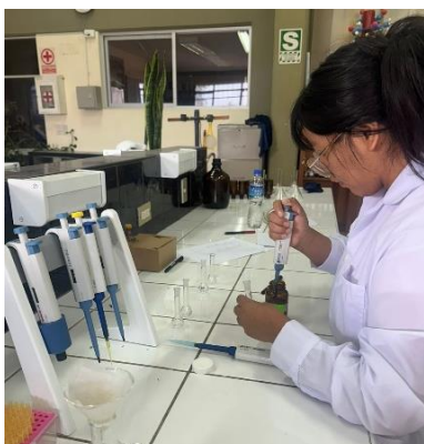
Figura 2. Adición del reactivo de Lieberman - Burchard y ácido acético al 50%.
