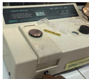
Figura 3. Lectura de la absorbancia de las soluciones estándar a 540 nm.
