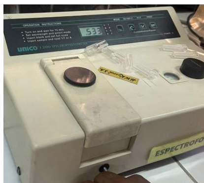
Figura 3. Lectura de la absorbancia de las diluciones estándar a 760 nm.
