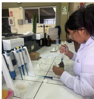
Figura 2. Adición del reactivo de FC Y carbonato de sodio.
