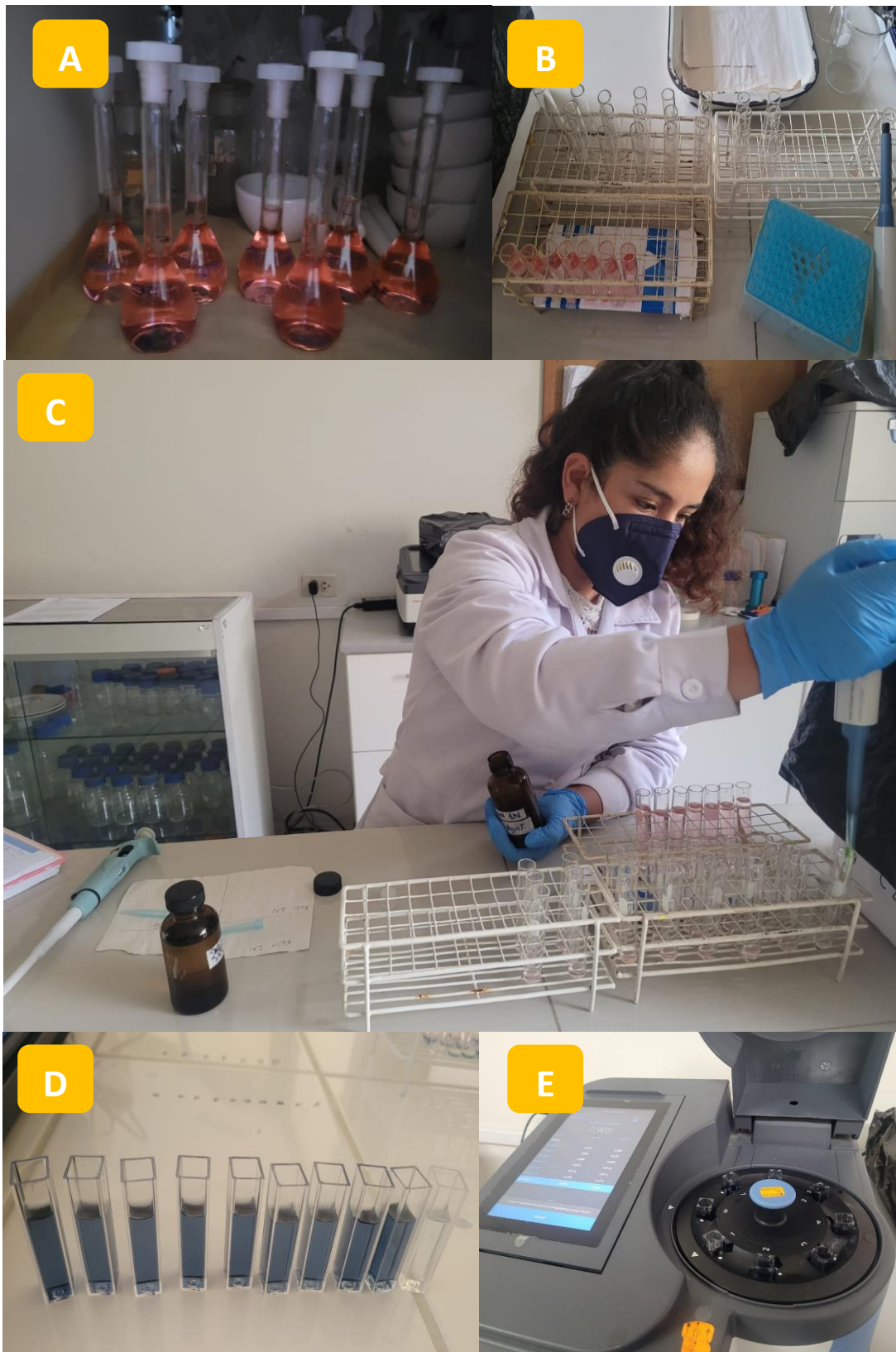
Figura 27. Proceso para la lectura de la absorbancia de los fenoles.
