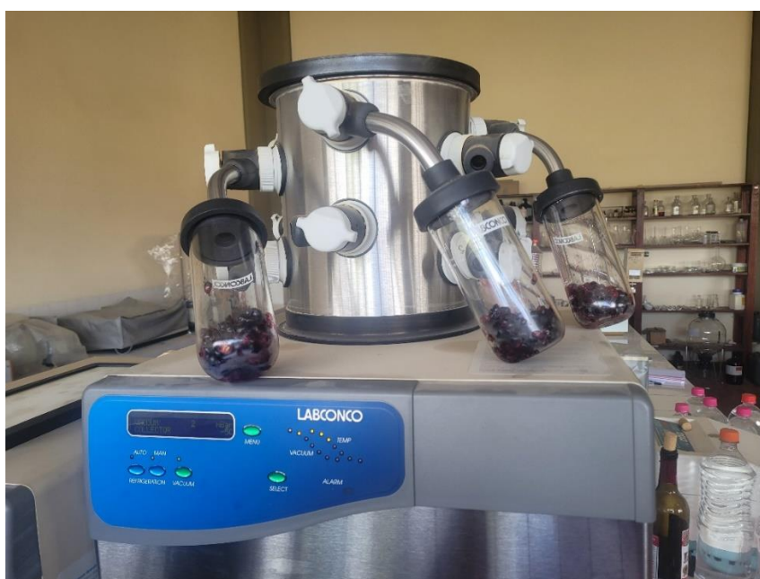
ANEXO 5. Liofización de la muestra de los frutos del ayrampo.
