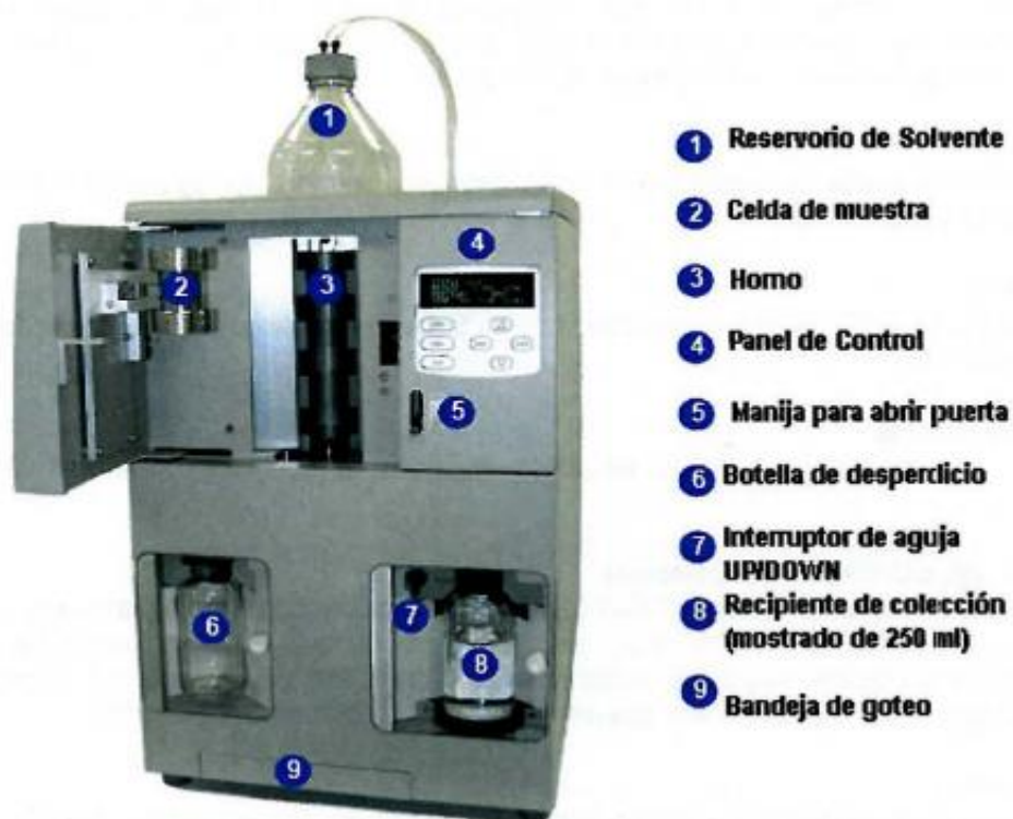
Figura 5. Principales características de operación del ASE 150 extractor de solvente acelerado.
