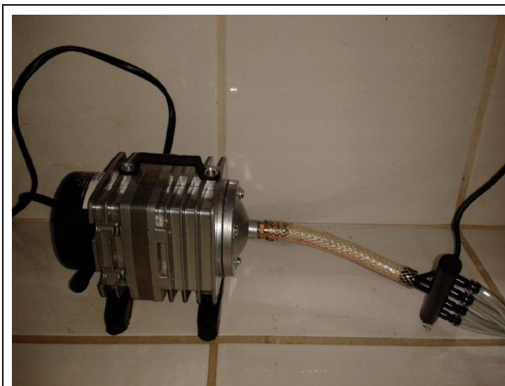
Fotografía 5. Compresora de aire, utilizado para generar aire.
