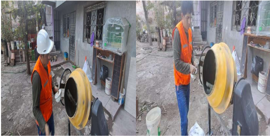
26.- Agregando las fibras de polipropileno a la mezcla fresca
