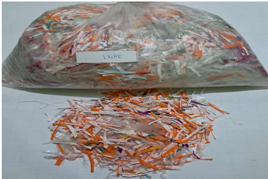
Figura 12: Fibras de polietileno de baja densidad reciclado (LDPE)
