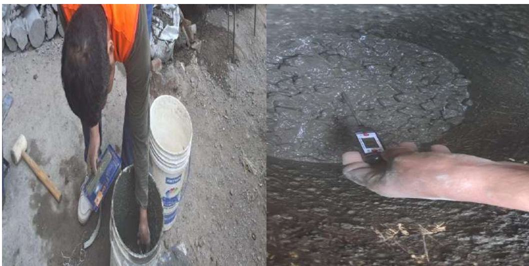
29.- Medición de temperatura para las siguientes dosificaciones
