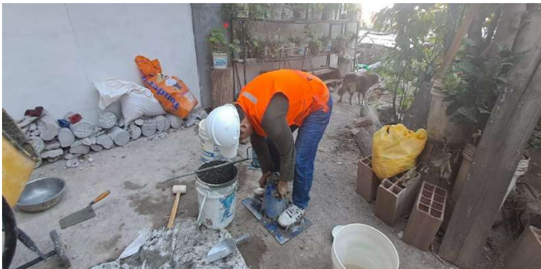
29.- Medición de temperatura para las siguientes dosificaciones
