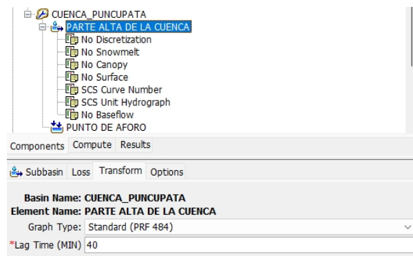
Imagen 3.50: Ingreso del Tiempo de Retardo de la Cuenca Puncupata al programa HEC-HMS
