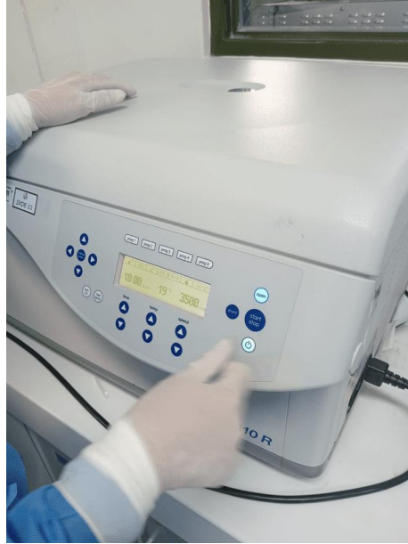
Figura 13. Centrifugado de los tubos a 3500 rpm durante 10 minutos.
