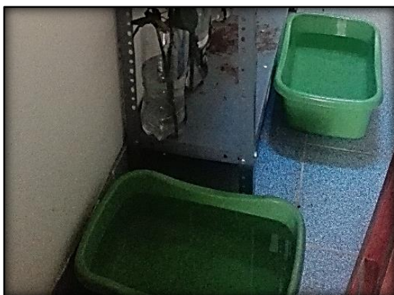
Fotografía 3.9: Tinas con agua para generar mayor humedad en el ambiente.
