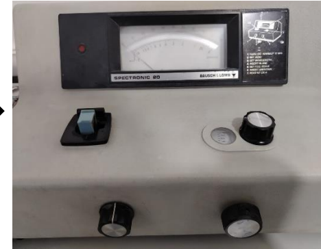
Se calibró el espectrofotómetro a 540nm, utilizando con blanco el reactivo Drabkin.
