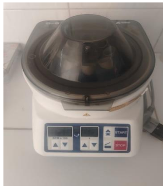
se centrifugó la muestra a a 10,000 rpm por 5 minutos.
