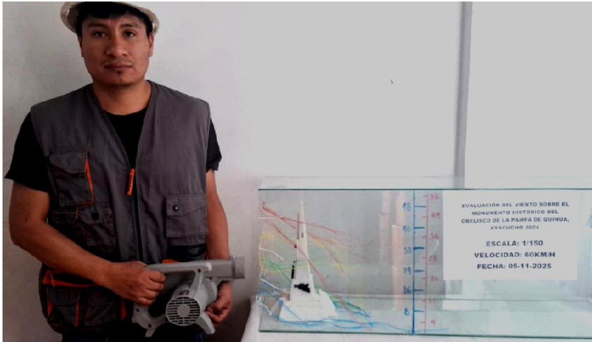
Figura 4.70: Experimento a escala para evaluar las líneas de corriente
