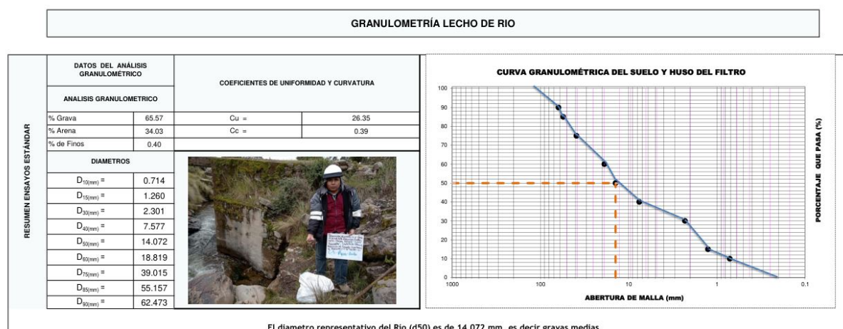
Imagen 3.60: Granulometría del material del lecho del río.
