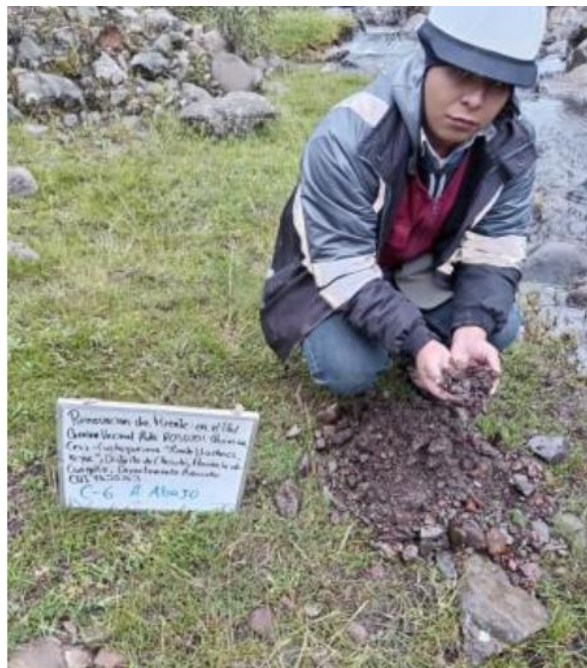
(b) Obtención de la muestra de calicatas aguas abajo.
