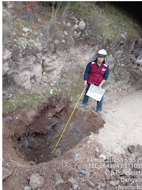
(a) Obtención de la muestra de calicatas aguas arriba.
