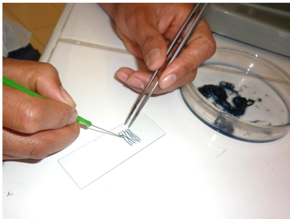
Imagen 12. Montaje de raíces de café en portaobjeto para su observación microscópica.
