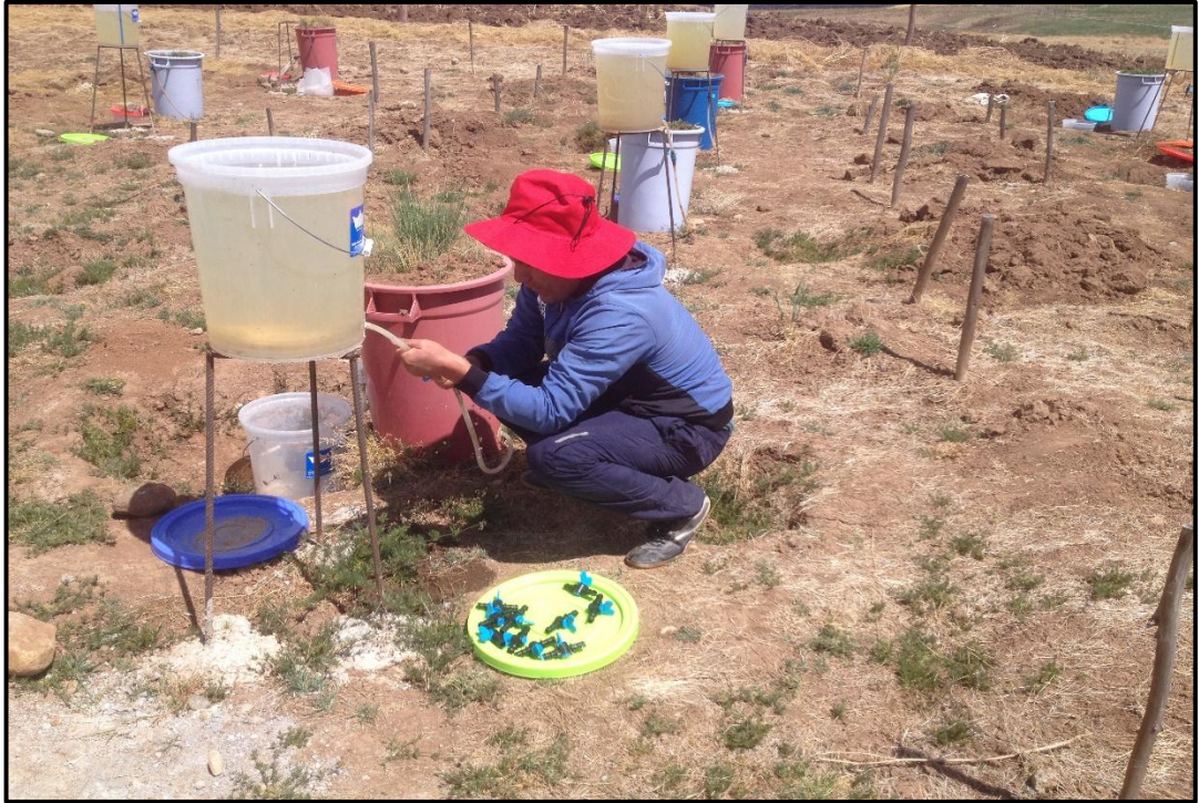
Figura J.9. Mantenimiento de los accesorios del lisímetro
