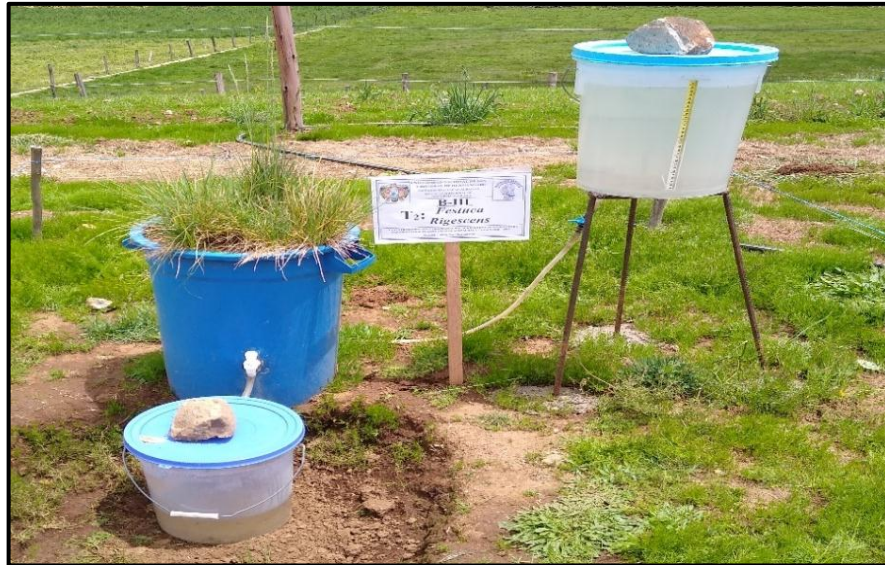
Figura 2.12. Lisímetro de nivel freático constante y sus componentes
