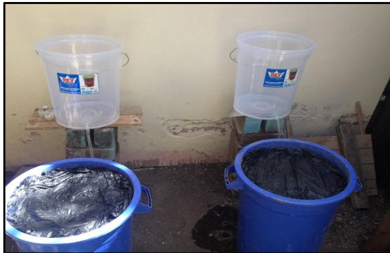
Figura 2.4. Prueba de lisimetría
