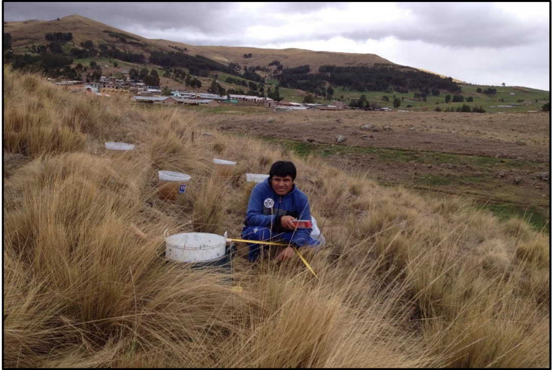
Figura J.3. Prueba de infiltración N° 02
