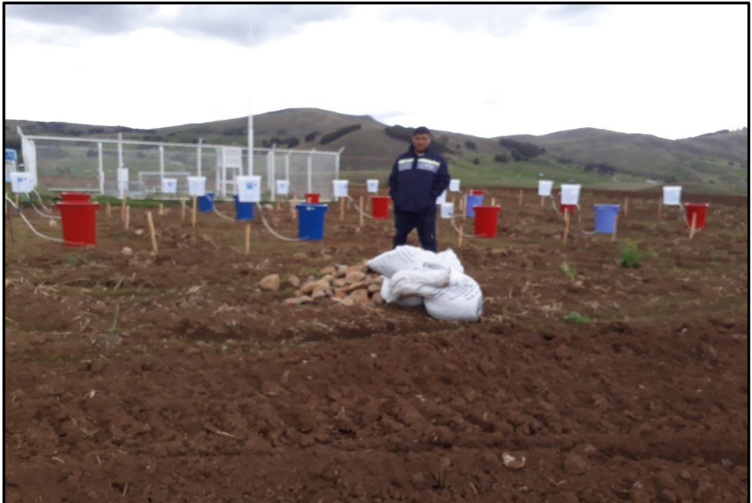
Figura J.4. Llenado de piedra mediana, arena y tierra al lisímetro de nivel freático
