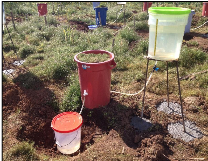
Figura 2.15. Drenaje de agua del tanque alimentador hasta el tanque de almacenamiento
