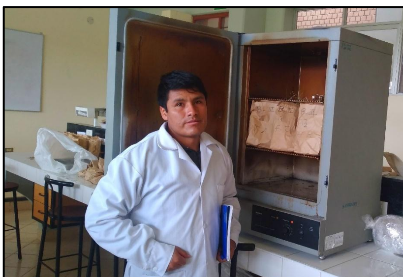
Figura 2.27. Secado a estufa para su peso seco de los pastos
