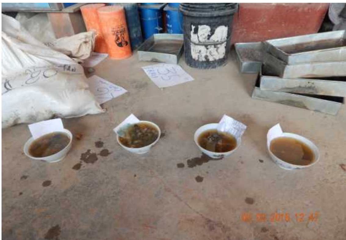
Foto 17: Muestras de agregados grueso sometidos a resistencia con sulfato de sodio
