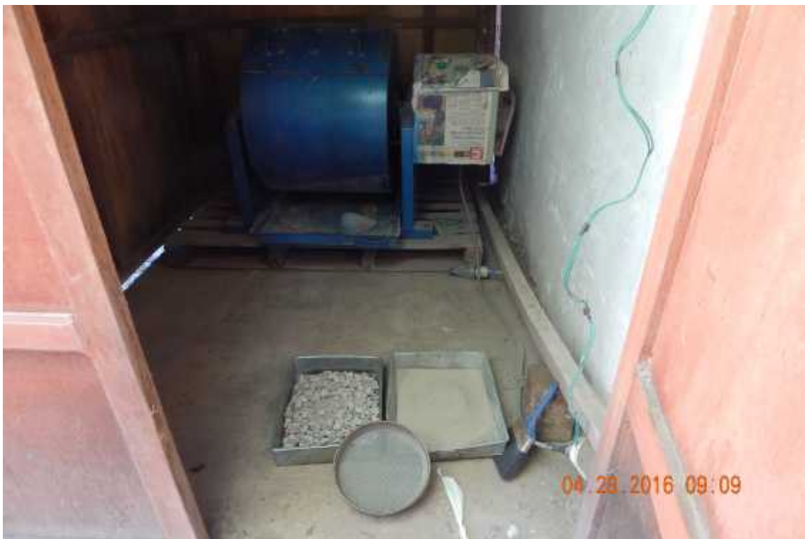
Foto 20: Tamizado de la prueba de resistencia al desgaste del agregado grueso y su posterior pesado
