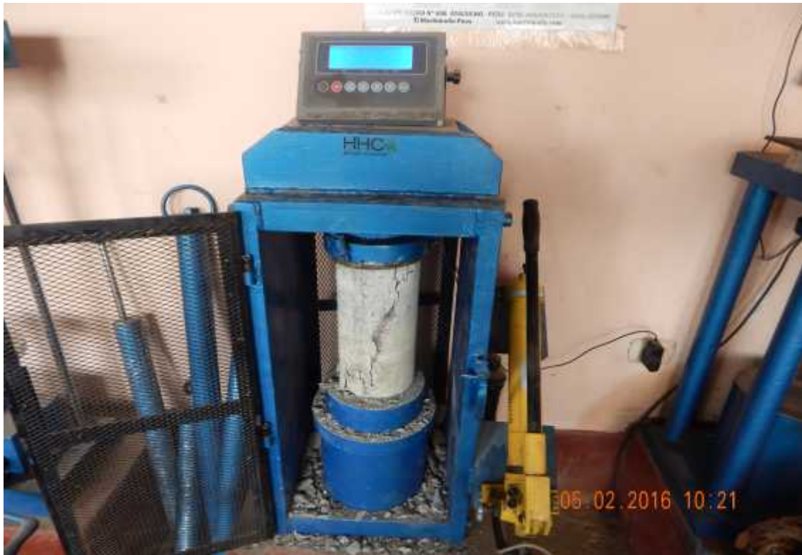
Foto 52: Rotura de muestras de testigo a compresión del cuarto lote
