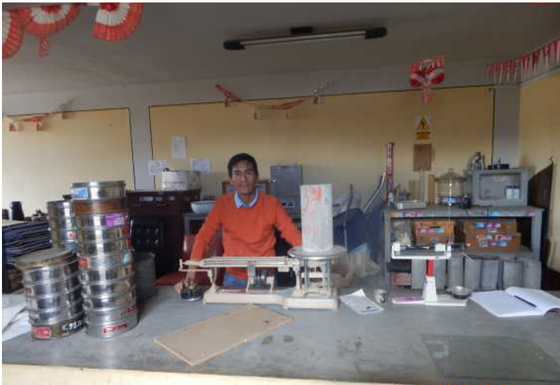
Foto 40: Control del peso de la muestra de concreto en el laboratorio
