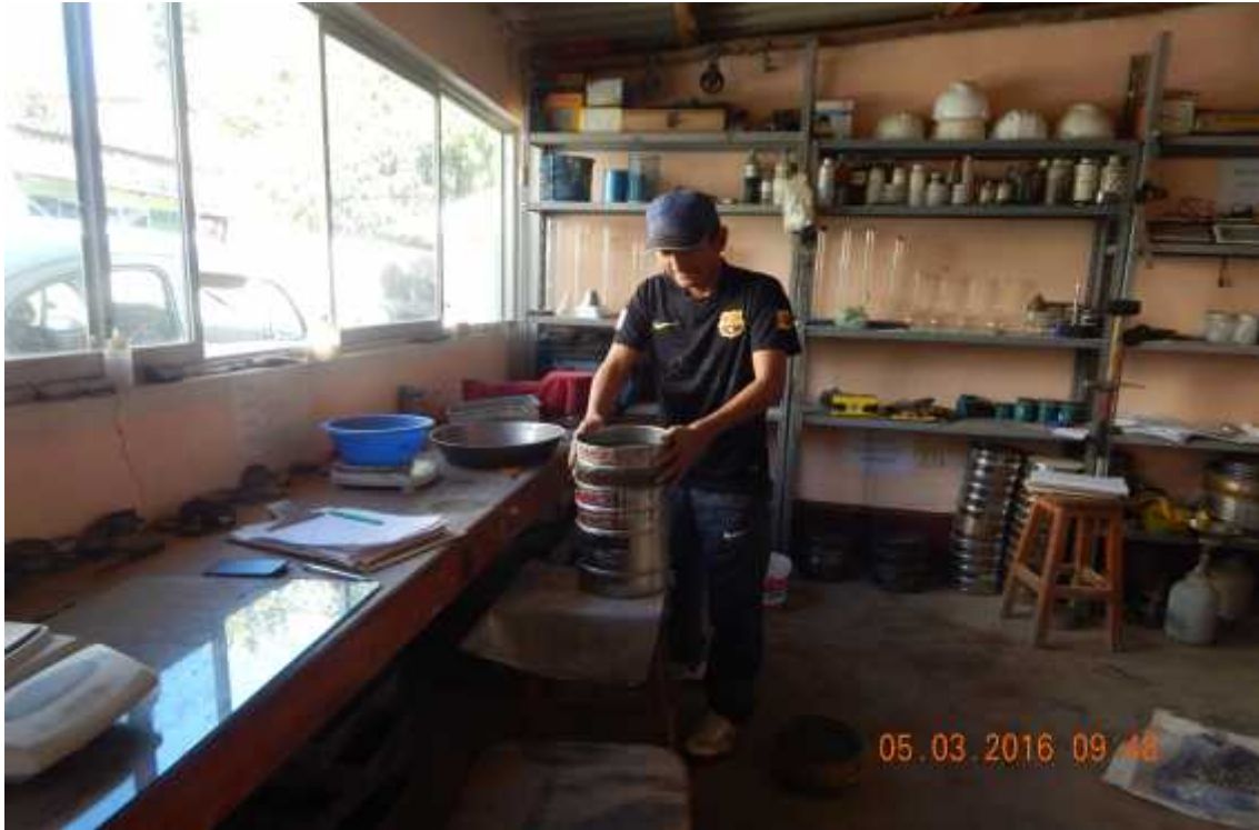
Foto 7: Análisis granulométrico del agregado fino (arena) con mallas N° 4; 8, 16; 30; 50; 100 y 200
