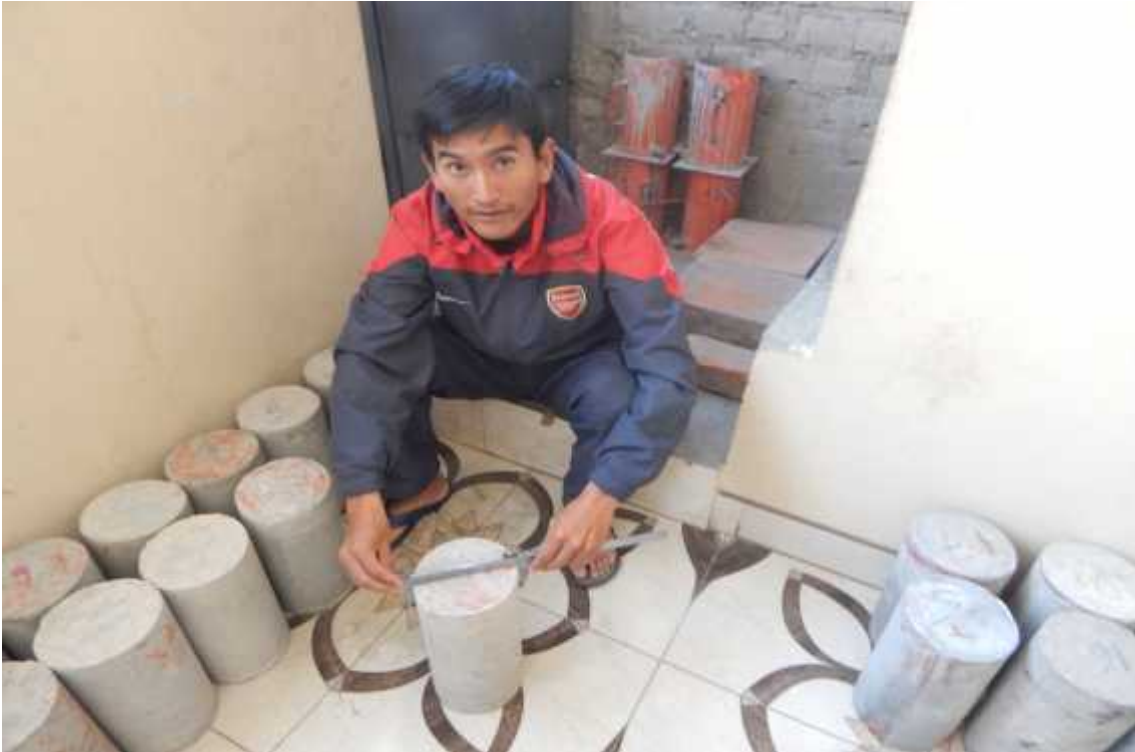
Foto 38: Control de las dimensiones de la muestra (diámetro y longitud), para determinar la relación D/H
