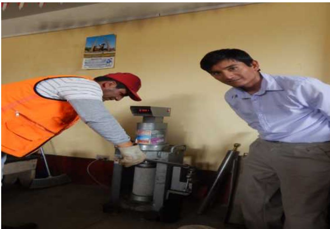
Foto 46: Procedimiento de rotura de las muestras de testigos segundo lote
