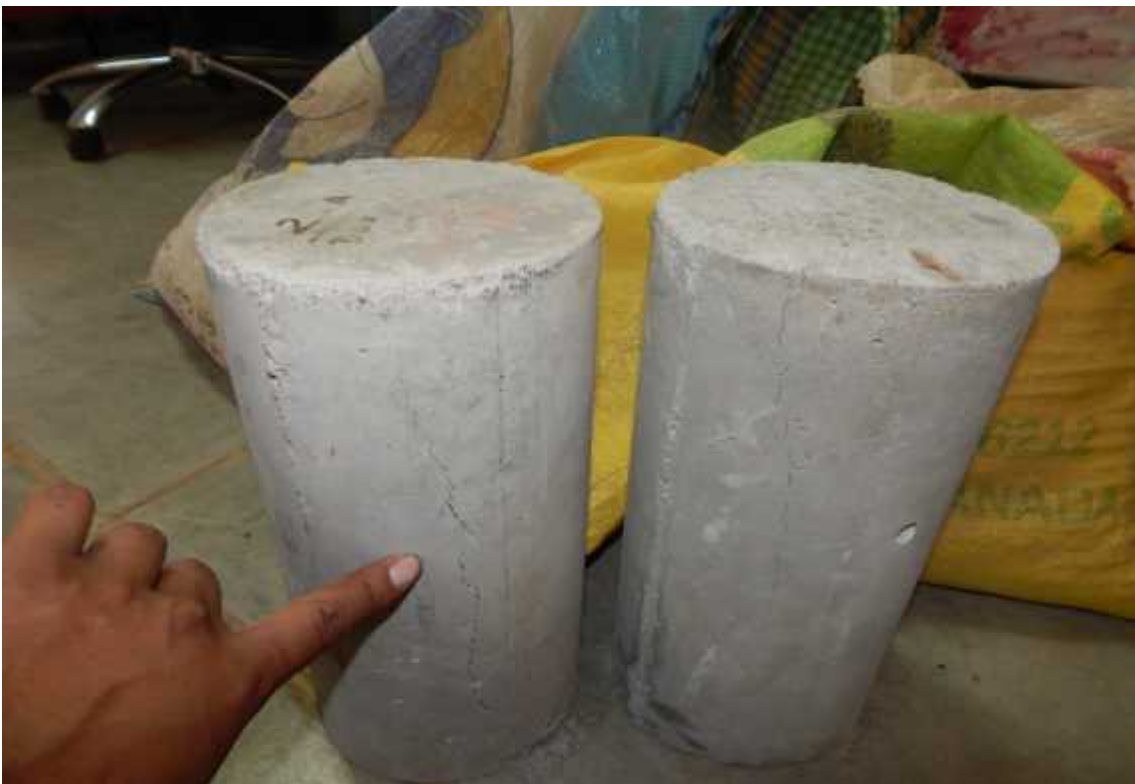
Foto 44: Tipos de fallas de dos muestra a compresión de vivienda N° 2
