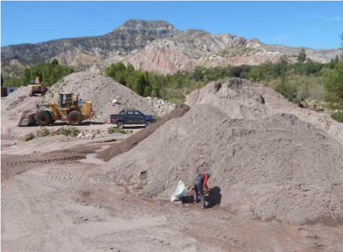
Foto 4: Toma de muestra de agregado fino (arena) en las canteras mismas
