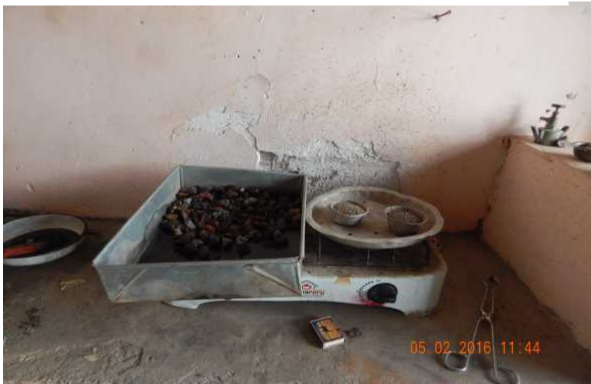
Foto 14: Secado y su posterior pesado del agregado grueso y fino
