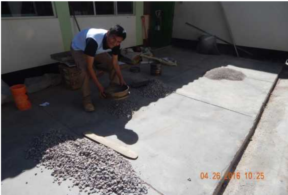
Foto 6: Análisis granulométrico de la piedra chancada con mallas 1 ½", 1", ¾", ½", 3/8", N°4
