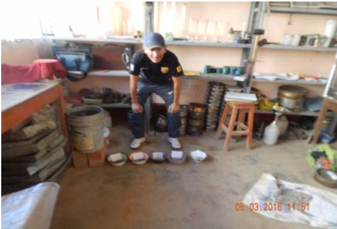
Foto 15: Pesado de agregado fino para prueba de resistencia a sulfato de sodio
