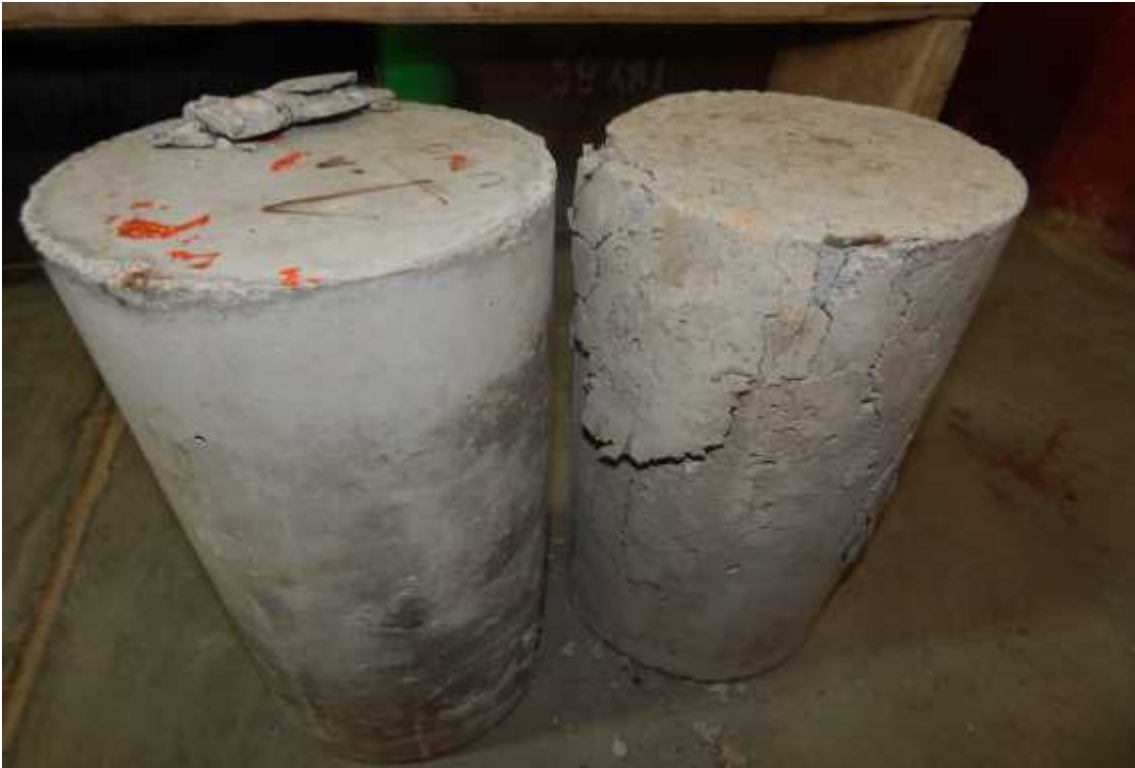
Foto 43: Tipo de falla a compresión de la muestra N° 1
