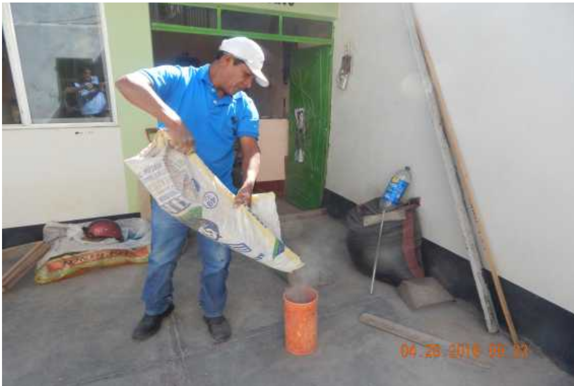
Foto 8: Peso unitario suelto del agregado fino (arena)
