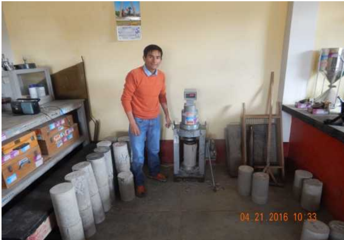
Foto 49: Procedimiento de rotura de muestras del tercer lote de losas aligeradas de viviendas
