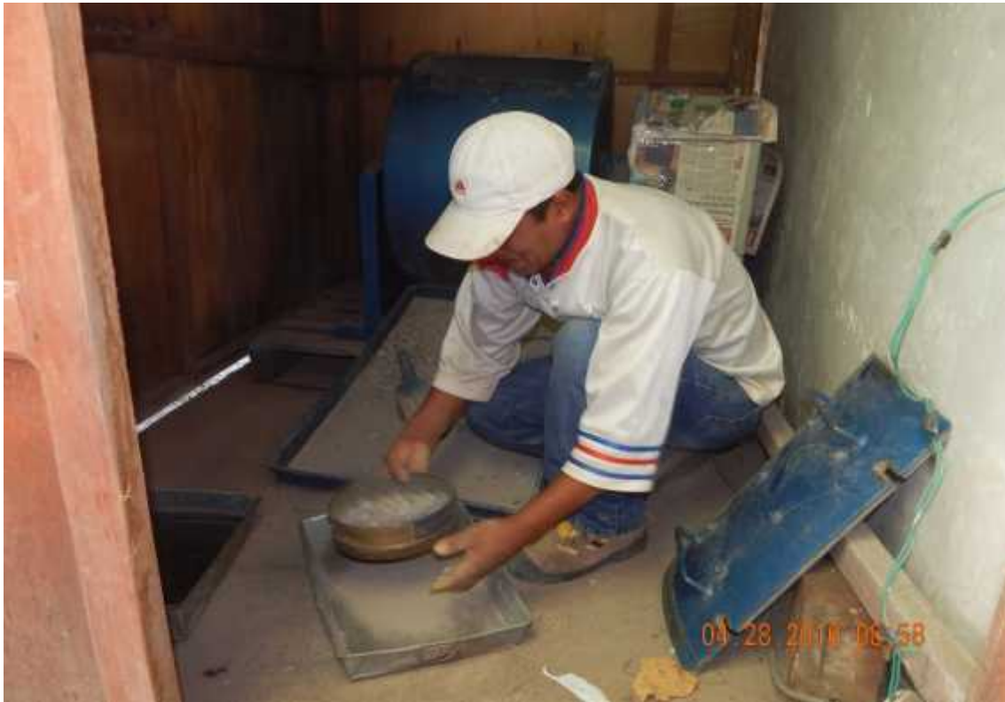
Foto 19: Prueba de resistencia del agregado grueso y su tamizado con malla N°12
