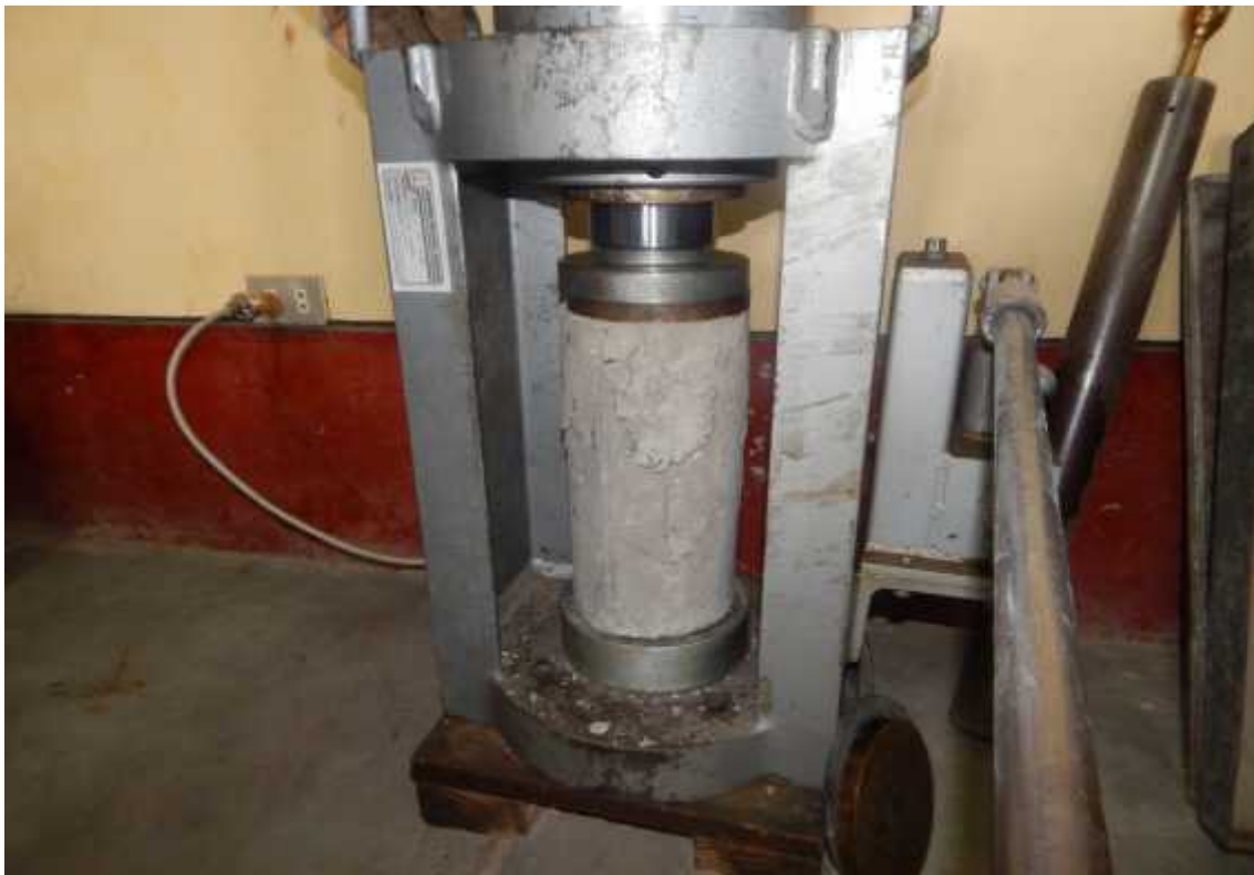
Foto 42: Tipos de fallas a compresión de las muestras obtenidas
