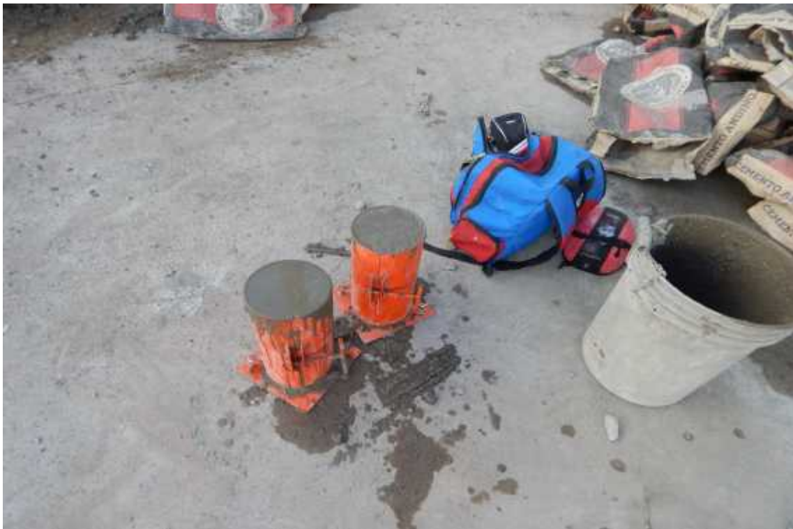
Foto 10: Toma de muestra de concreto en losa de vivienda N° 5
