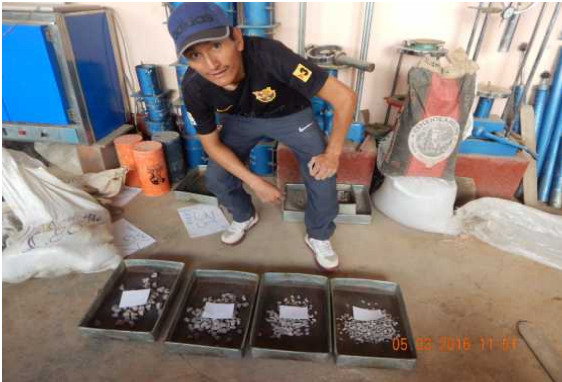
Foto 16: Pesado de las gravas para para prueba de resistencia a sulfato de sodio
