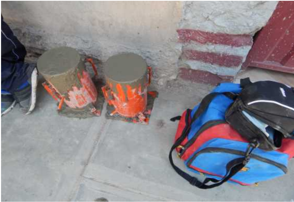
Foto 21: Toma de muestra de concreto en losa de vivienda N° 11
