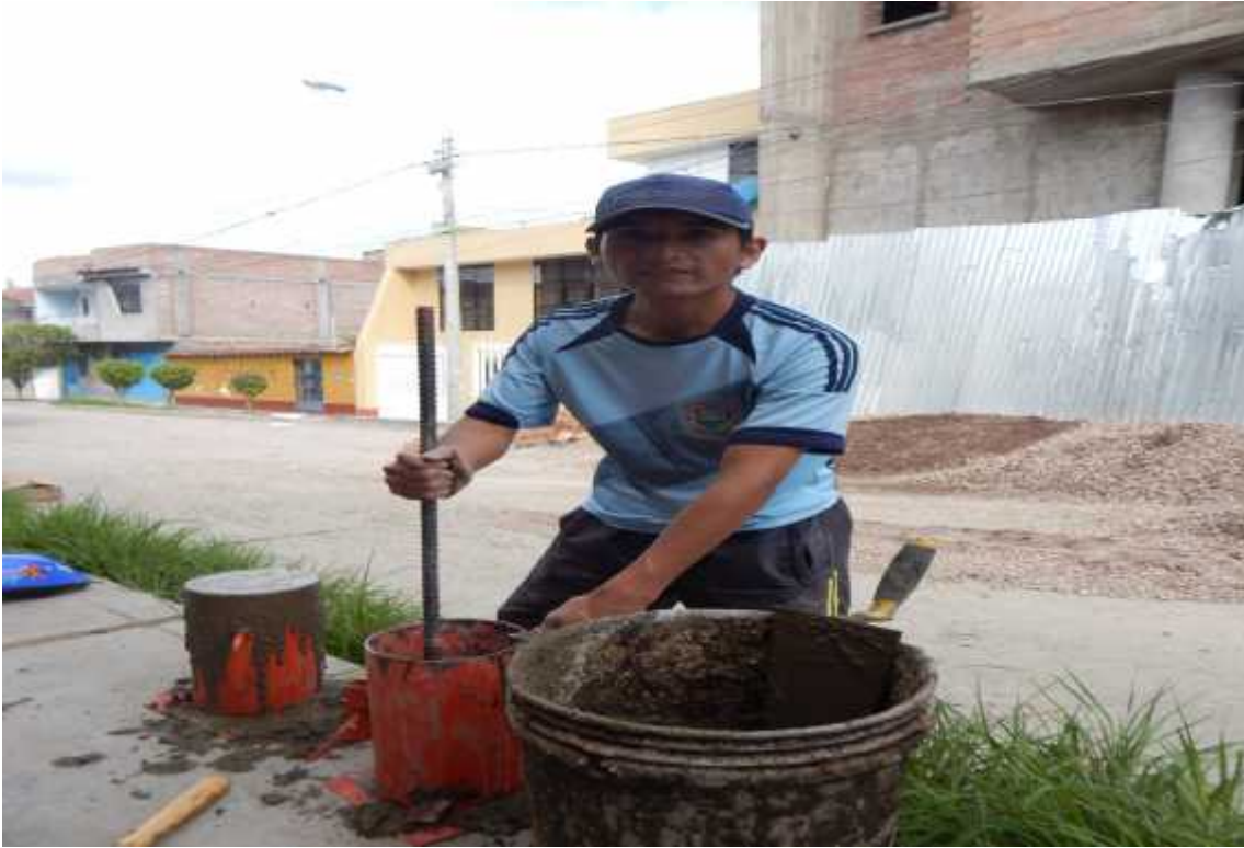
Foto 17: Toma de muestra de concreto en losa aligerada de vivienda N° 9
