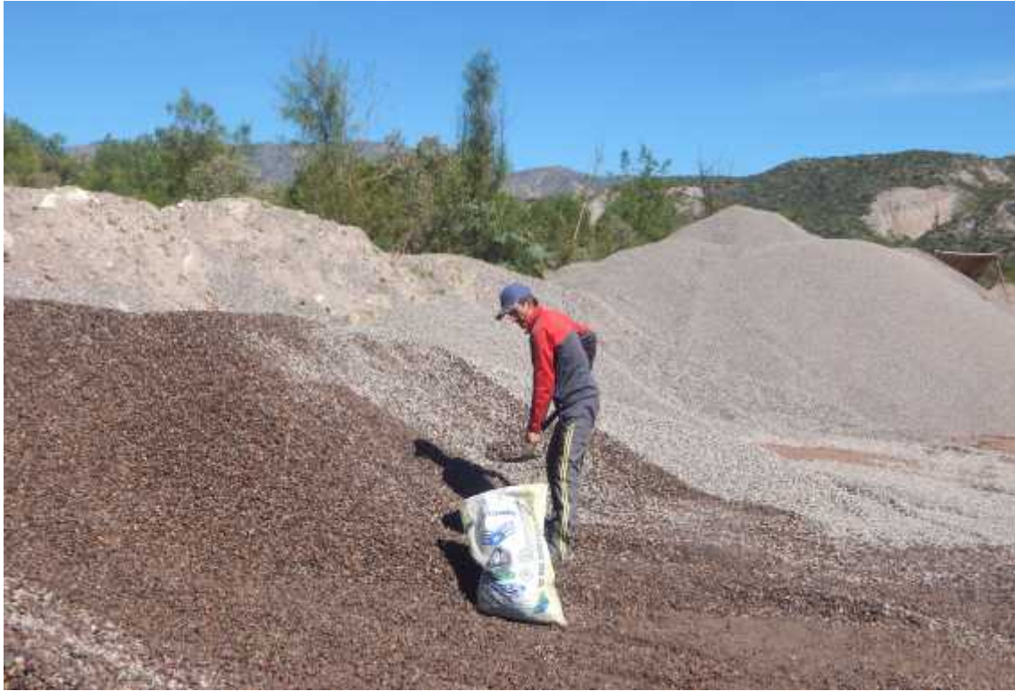
Foto 5; Toma de muestra del agregado grueso (piedra chancada en las canteras mismas)
