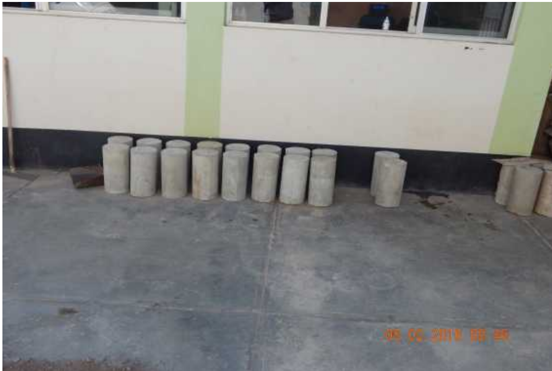
Foto 51: Rotura de muestras de concreto a compresión del cuarto lote
