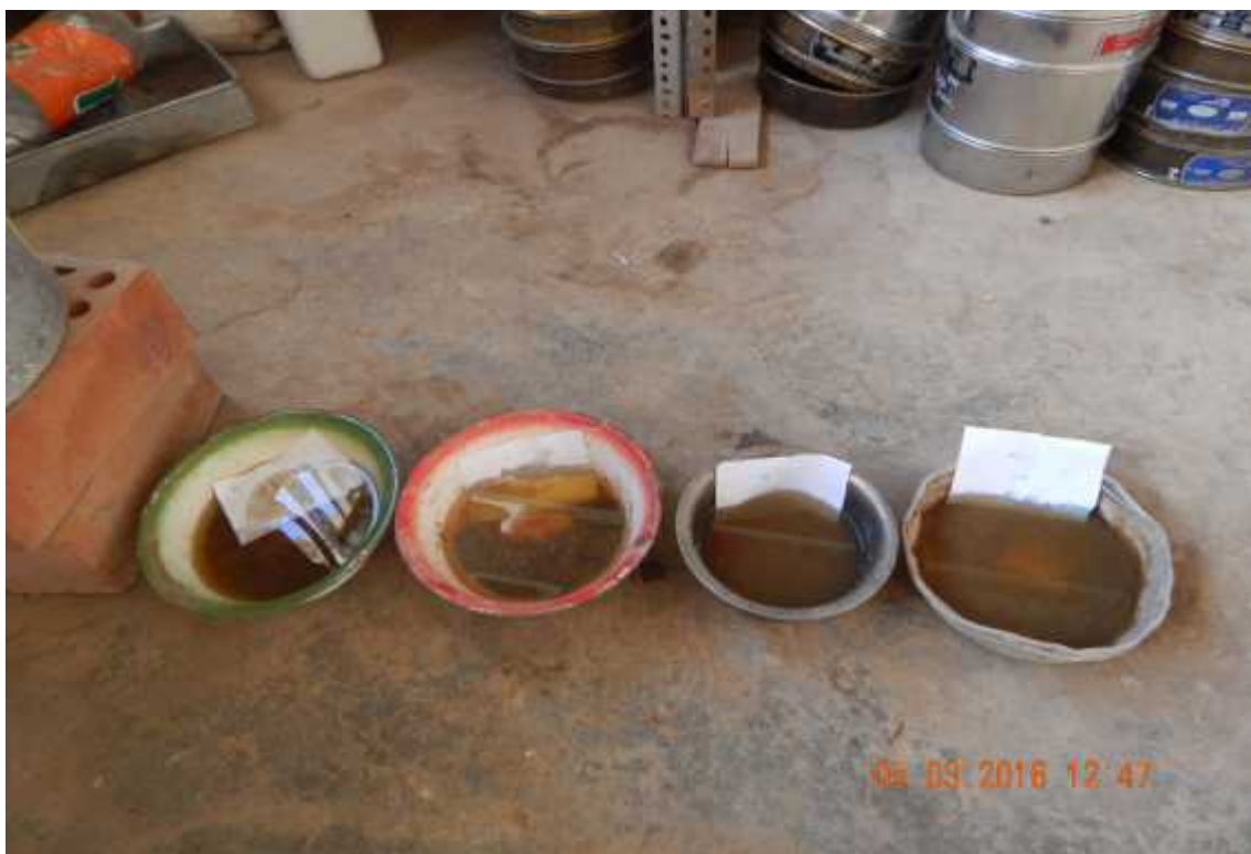
Foto 18: Muestras de agregado fino sometido a resistencia con sulfato de sodio
