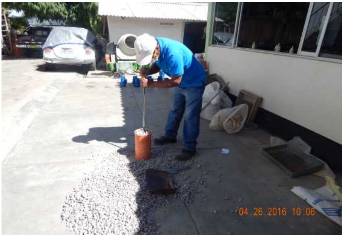
Foto 11: Peso unitario compactado de la piedra chancada
