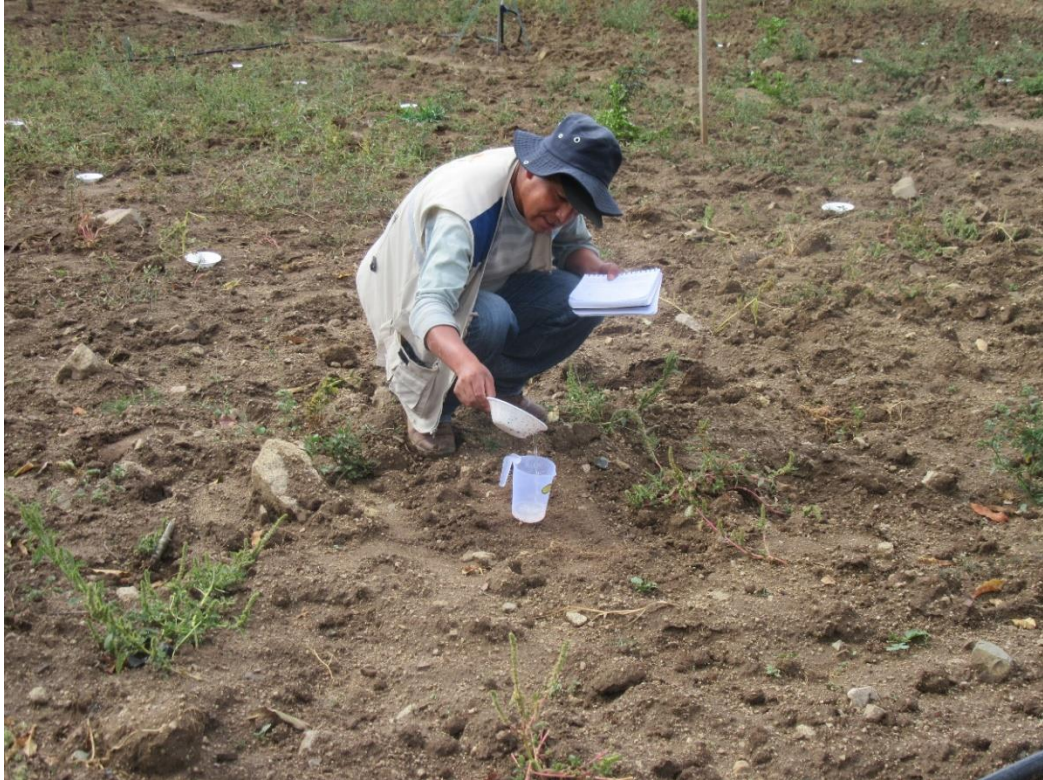
Fotografía 9: Medición de los volúmenes de cada uno del vaso.
