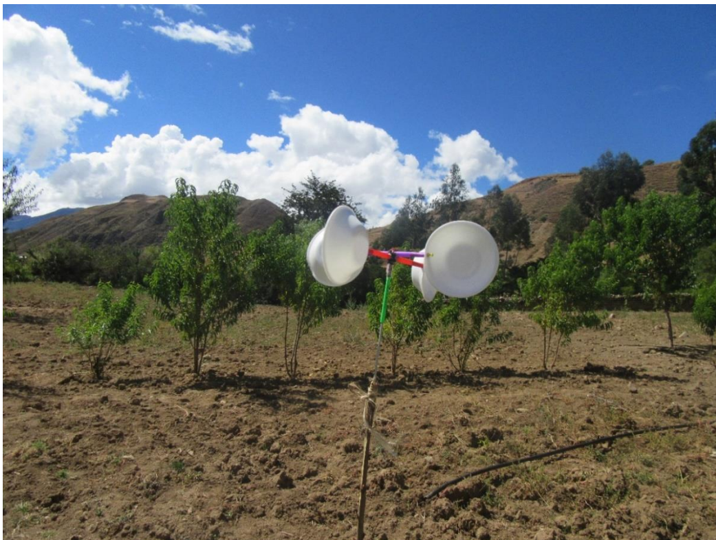
Fotografía 6: Medición de la velocidad de viento (Anemómetro Casero).
