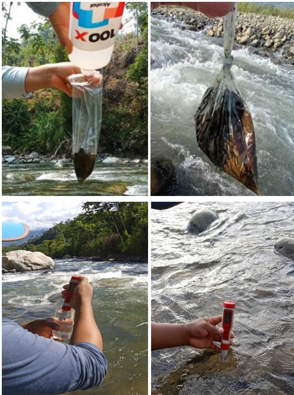
Anexo 14. Imágenes de la colecta de muestra de la comunidad macroinvertebrada en bolsas de polietileno conteniendo alcohol al 96% y la determinación in situ de los principales parámetros mediante un dispositivo multiparamétrico en el río Pichari.
