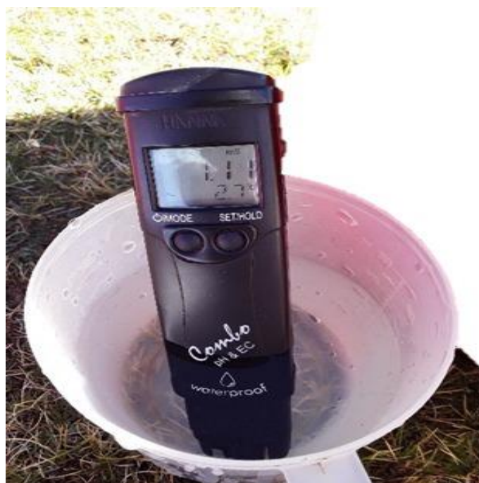
Anexo 14. Toma de datos de las características fisicoquímicas del agua in situ muestras del río Mijiamayo y tres tributarios. Samugari, La Mar – Ayacucho 2023.
