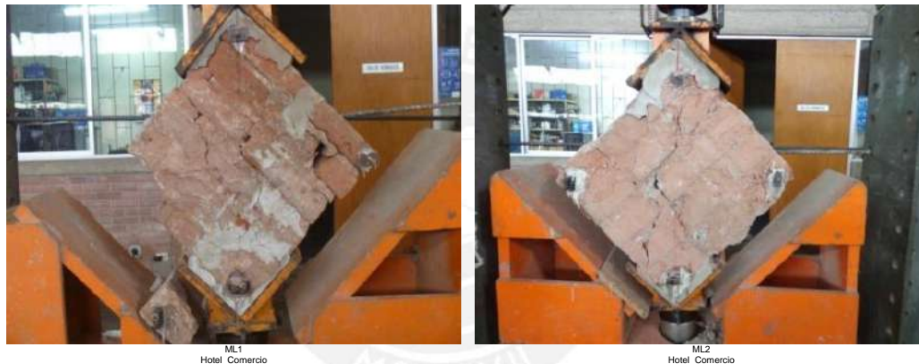
Fig. 79 – Muretes de ladrillo directamente extraídos
