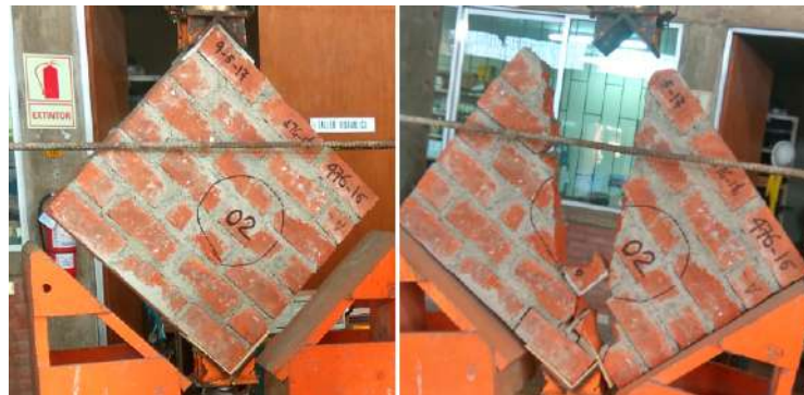
Figura 3.28: Falla típica del murete 02.
