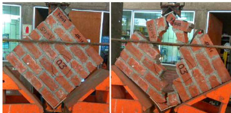
Figura 3.29: Falla escalonada del murete 03.
