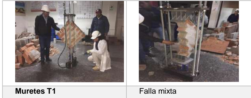
Figura 21: Falla de muretes T1 de ladrillo con mortero tradicional
