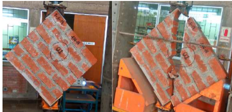
Figura 3.27: Falla típica del murete 01.
