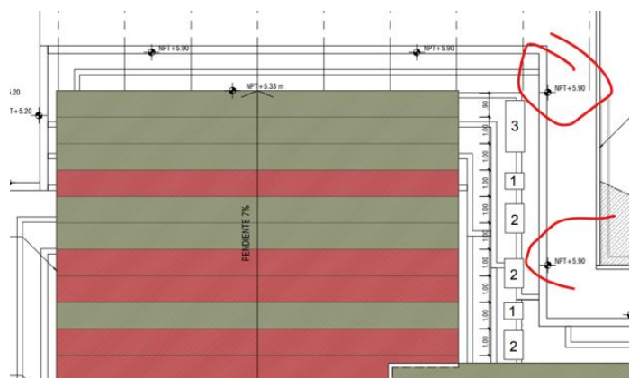
Figura 3.32: Quinta incompatibilidad de especialidades de Arquitectura y Estructura.
