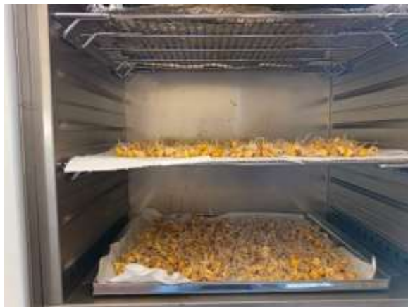
3. Secado de malta a 55°C por 48 h.
