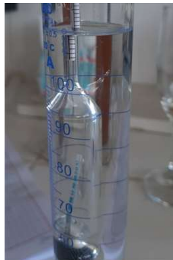
4. Lectura del contenido de alcohol (%v/v) en las muestras de cerveza
