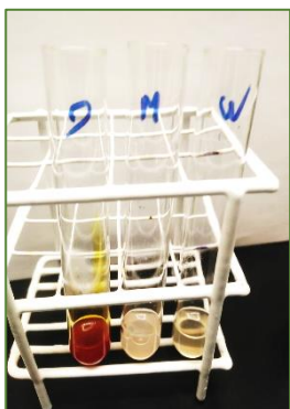
Ensayo de Dragendorff, Mayer y Wagner (izq. A dcha.). Extracto acuoso
