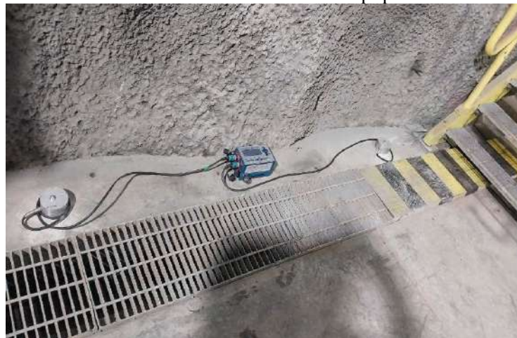
Figura 24. Equipo sismográfico INSTANTEL MINIMATE PRO 6 en el pique Yauricocha
