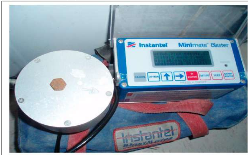
Figura 4. Sismógrafo InstanTel, y geófono
