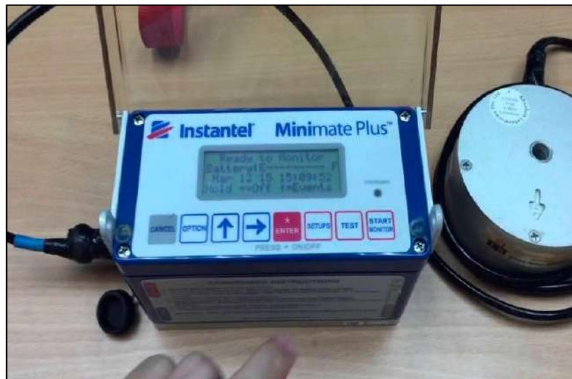
Figura 11. Equipos para el análisis de vibraciones Instantel
