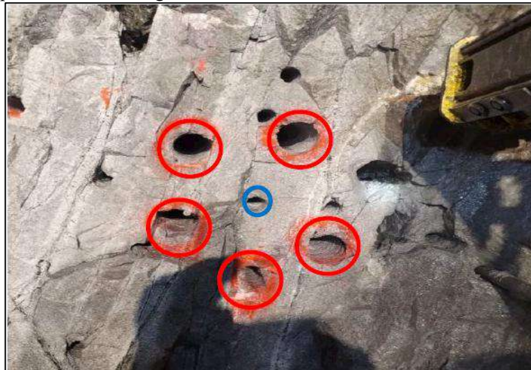
Figura 18. Sistema de arranque del frente Hexagonal
