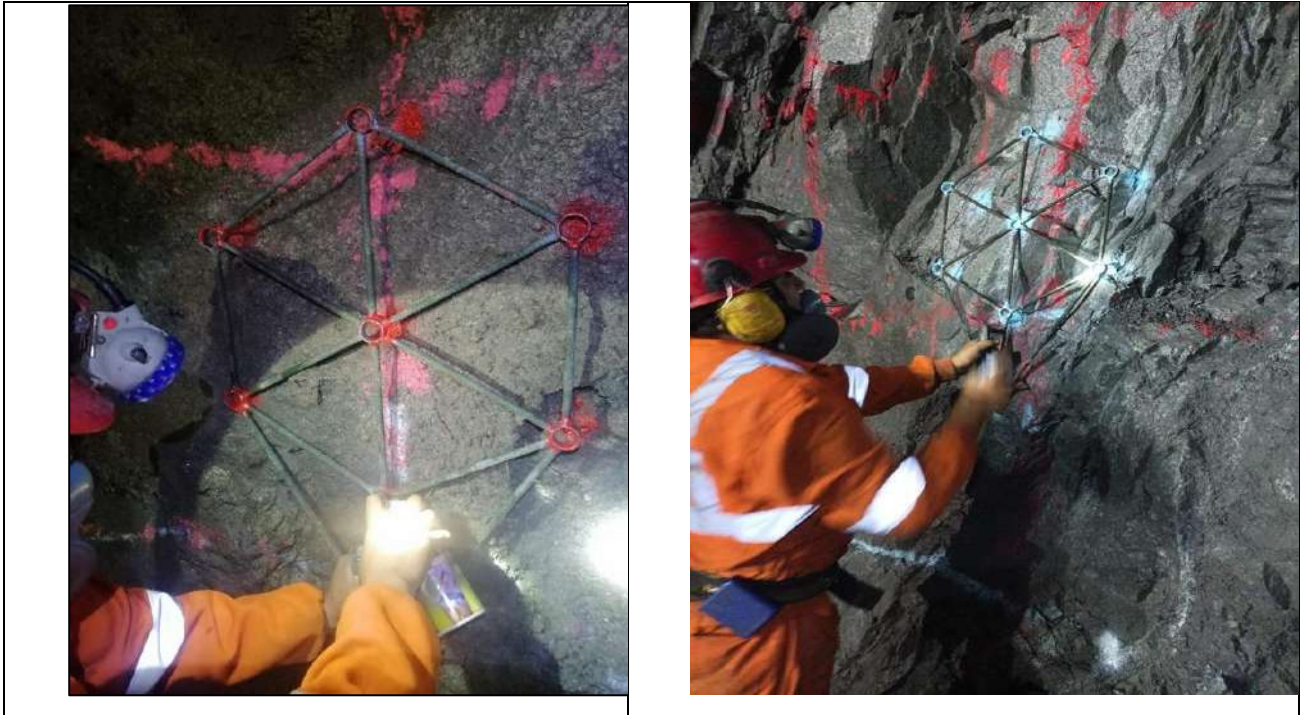
Figura 46. Plantilla de fierro de arranque
