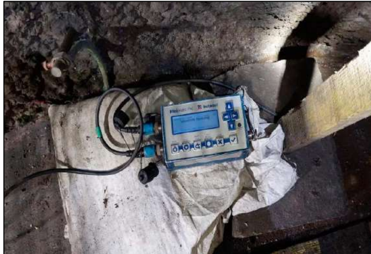
Figura 24. Equipo sismográfico INSTANTEL MINIMATE PRO 6 en el pique Yauricocha
