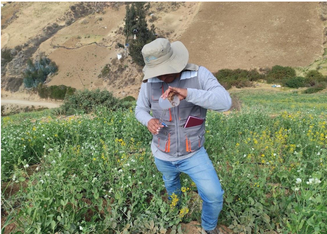
Fotografía 08: Toma de muestras de caudales del emisor, se observa se observa la medición del caudal en una probeta (para medir volumen en CC)
