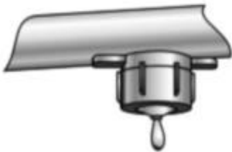
Gotero pinchado en una tubería lateral de riego
