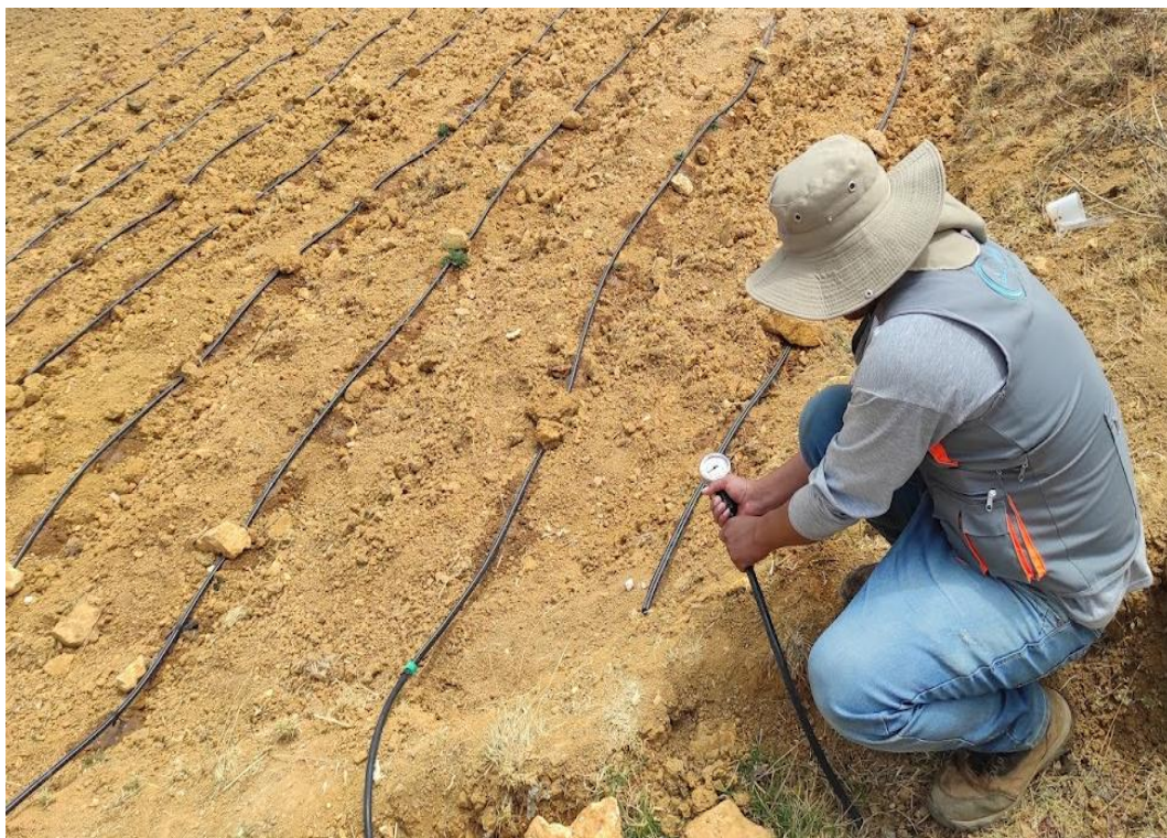
Fotografía 10: Toma de muestras de presiones de bigotes y entrada de agua hacia los laterales
