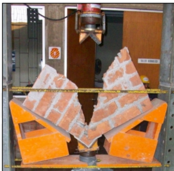
(a) Resistencia al corte del murete de albañilería tipo IV
