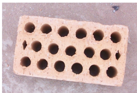
Figura 39. Unidad de albañilería tipo IV
