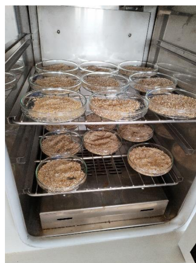
Foto 21. Análisis de humedad y materia seca en la estufa.
