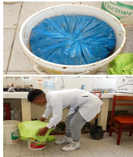
Foto 14. Compactación y sellado de las bolsas anaeróbicamente.
