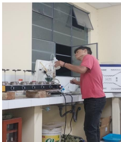
Foto 24. Análisis de proteína por destilación Kjeldahl.
