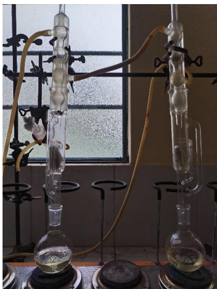
Foto 22. Análisis de Grasa en extractor soxhlet.
