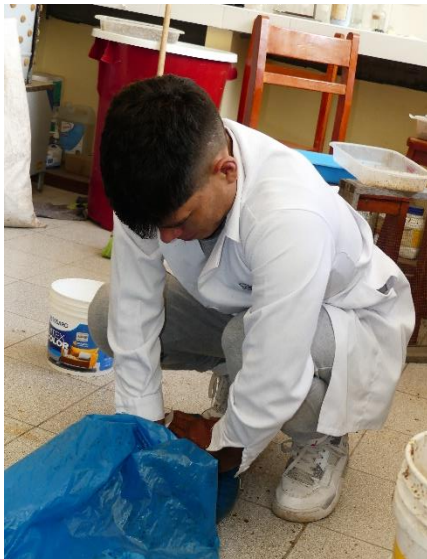
Foto 14. Compactación y sellado de las bolsas anaeróbicamente.
