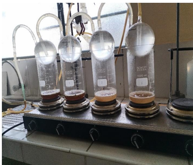
Foto 23. Análisis de fibra en digestores.
