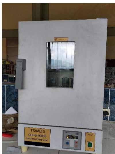
Foto 21. Análisis de humedad y materia seca en la estufa.
