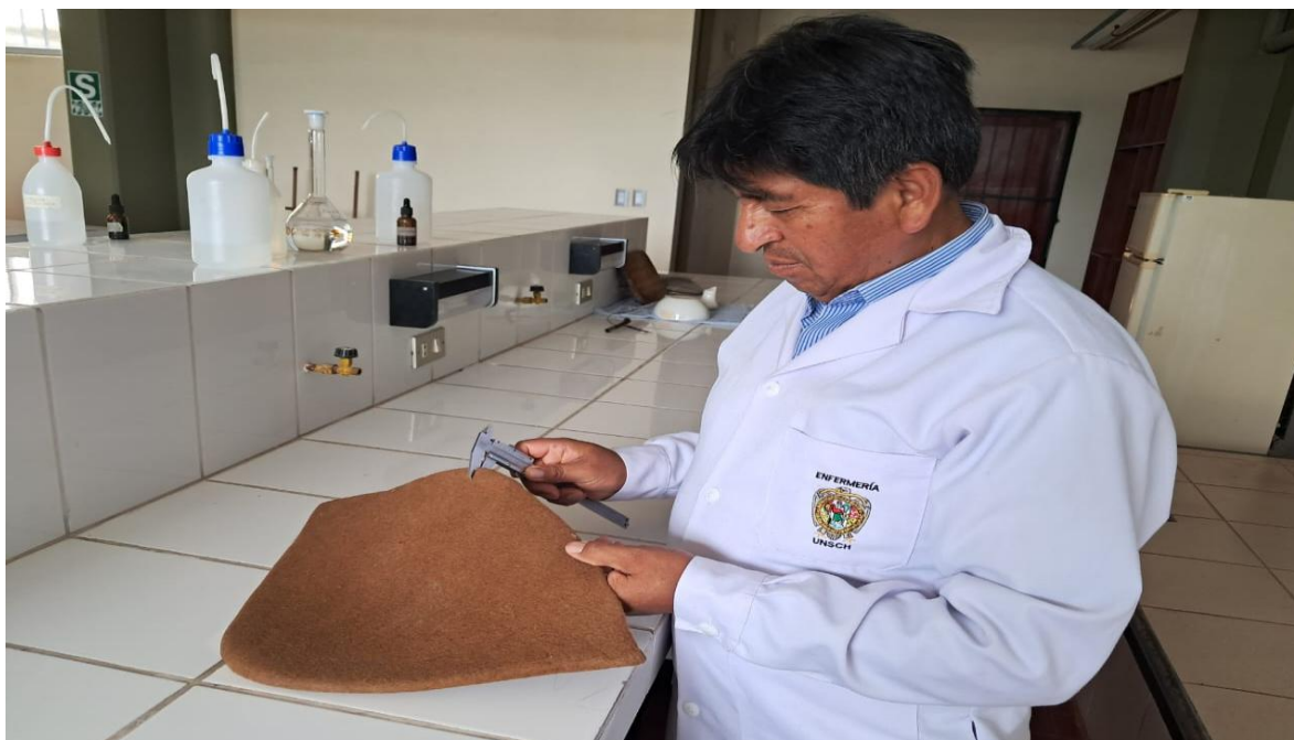
Figura 34 Medición del espesor de los diferentes fieltros
