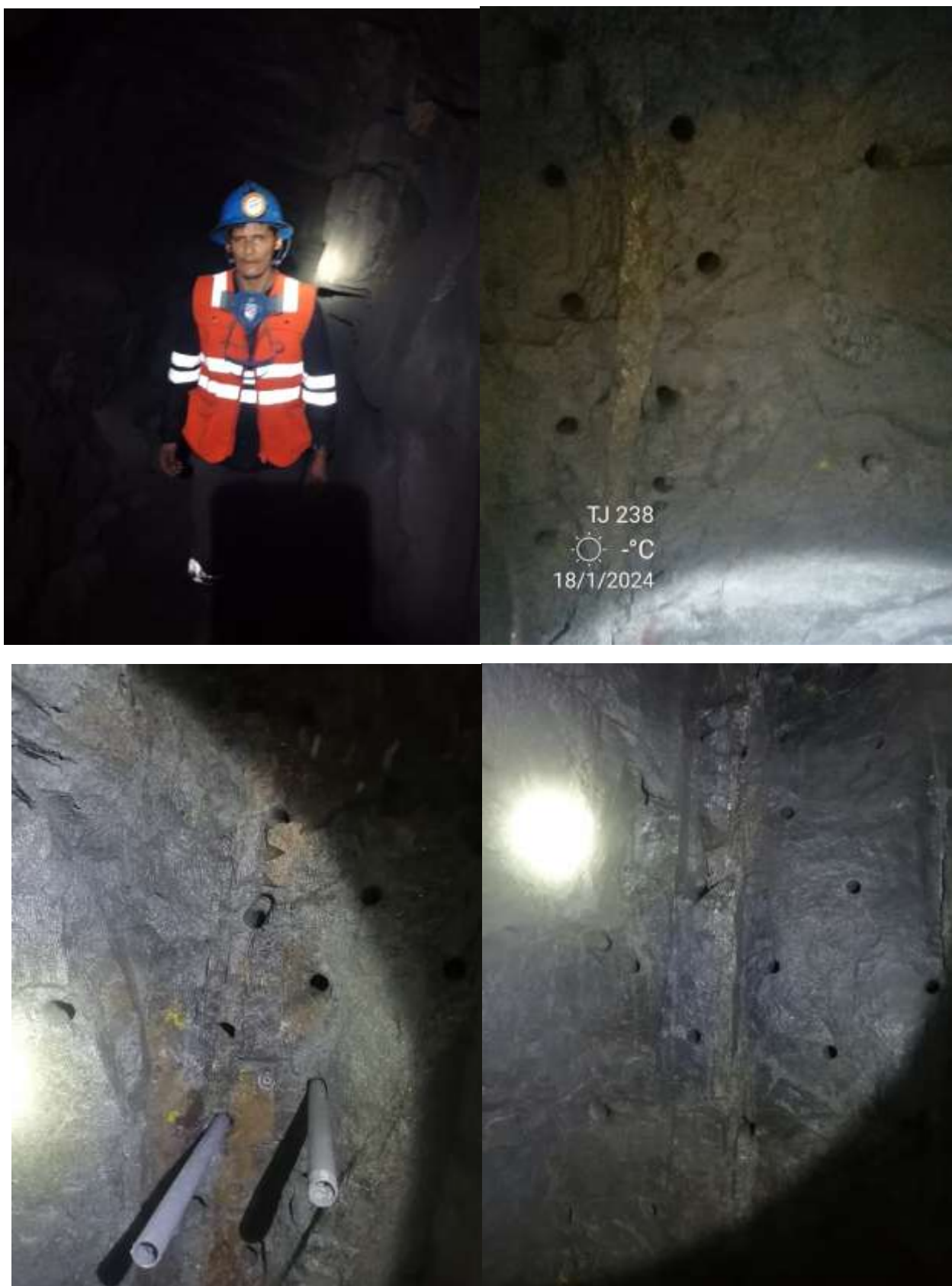
Foto: Marcado de malla de perforacio propuesta en Tj 238 y Tj 60 con una potencia de veta de 0.04 m
