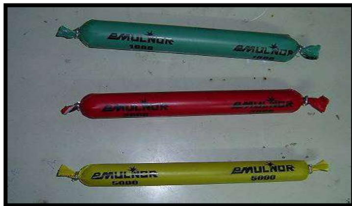
Figura 22: explosivos usados en voladura Fuente: Área operaciones orion
