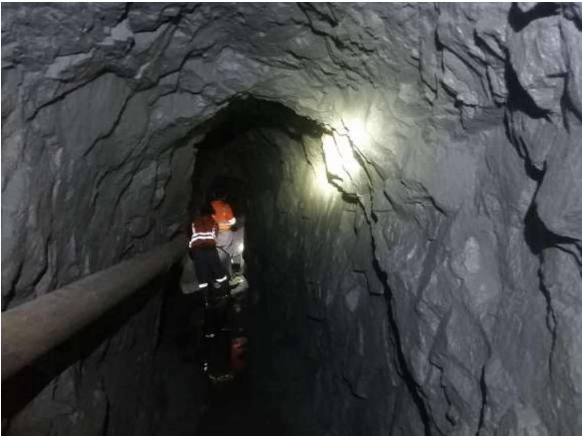
Foto: resultados en la corona despues de un corte, despues de disparo en Tj 238 y Tj 60 con una potencia de veta de 0.04 m
