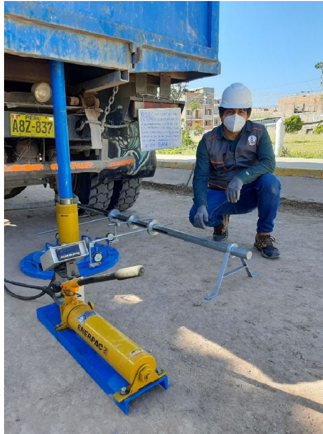
Ensamblaje del equipo del ensayo de Carga de Placa Estática.
