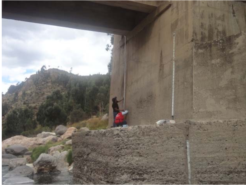
Vista 05: Regla graduada para registro de caudales en estribos derecho del puente Marita, en el río Caracha.
