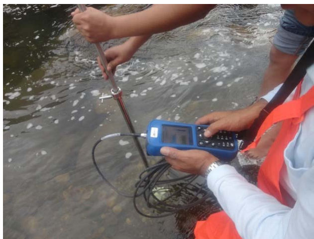
Vista 04: Registro de velocidades y profundidad con correntómetro aguas arriba del puente Marita, en el río Caracha.
