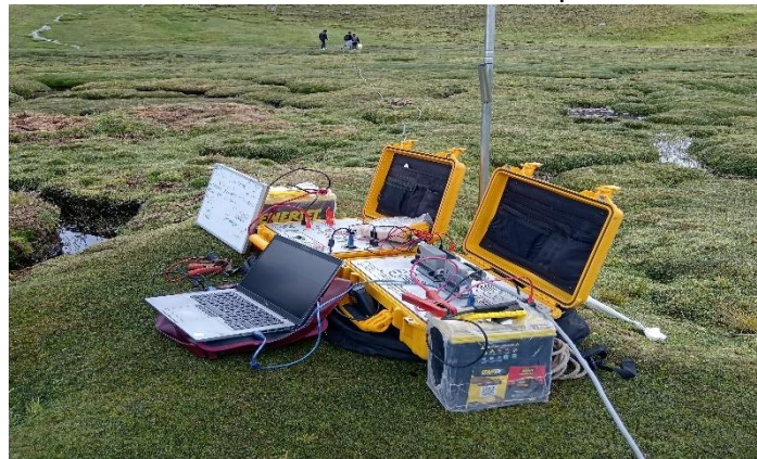
Figura N°5 Sismógrafo SeismeX16/24 con geófonos de 4.5 Hz utilizados en la salida de campo
