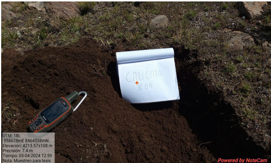
IMAGEN 24: Muestreo del suelo; calicata N° 05
