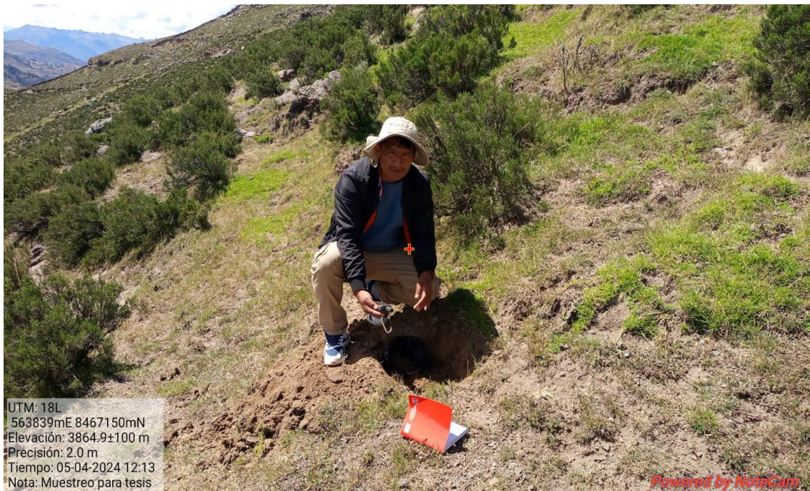
IMAGEN 23: Muestreo del suelo; calicata N° 05
