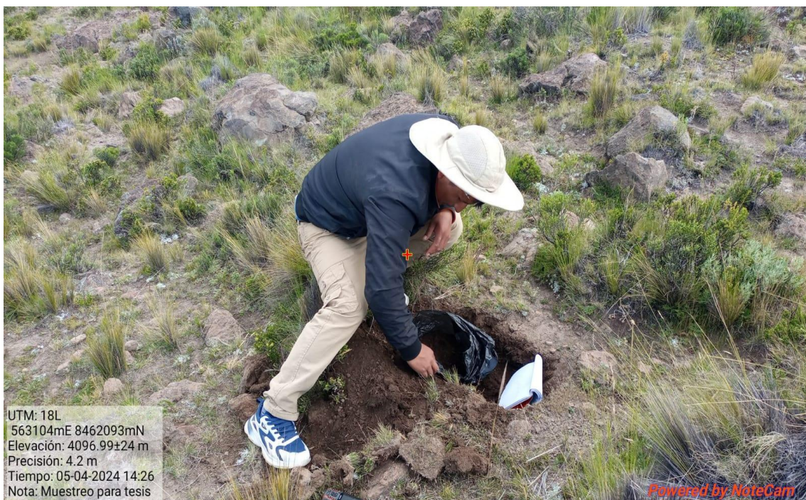
IMAGEN 28: Muestreo del suelo; calicata N° 07
