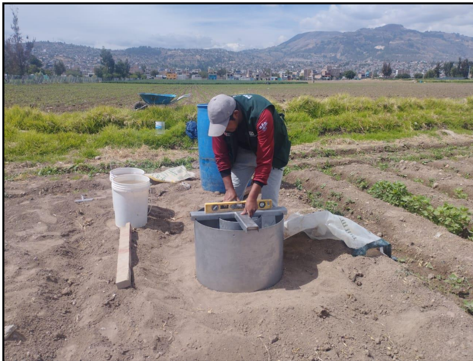
Fotografía 2: Prueba de infiltración por método de doble anillo
