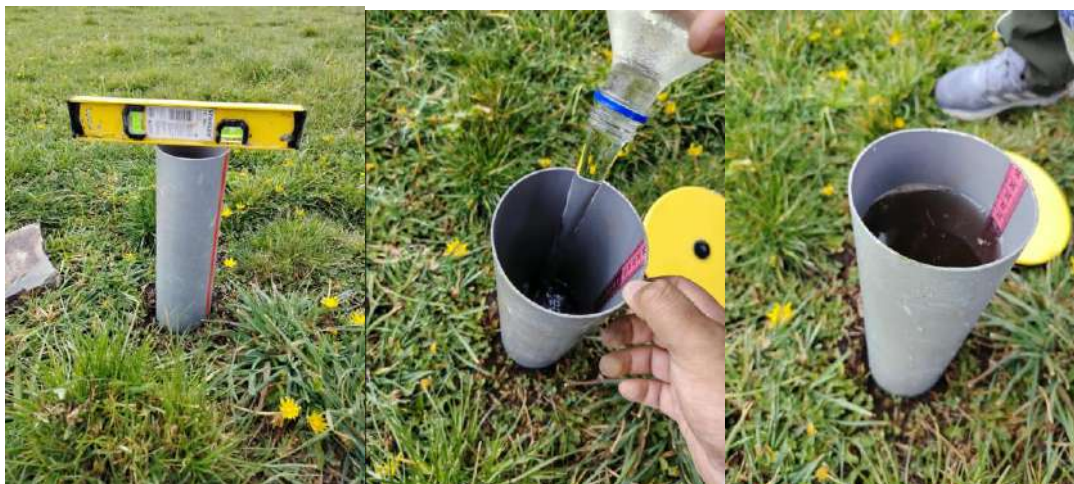
Figura 77. Proceso de prueba de infiltración en cada parcela.
