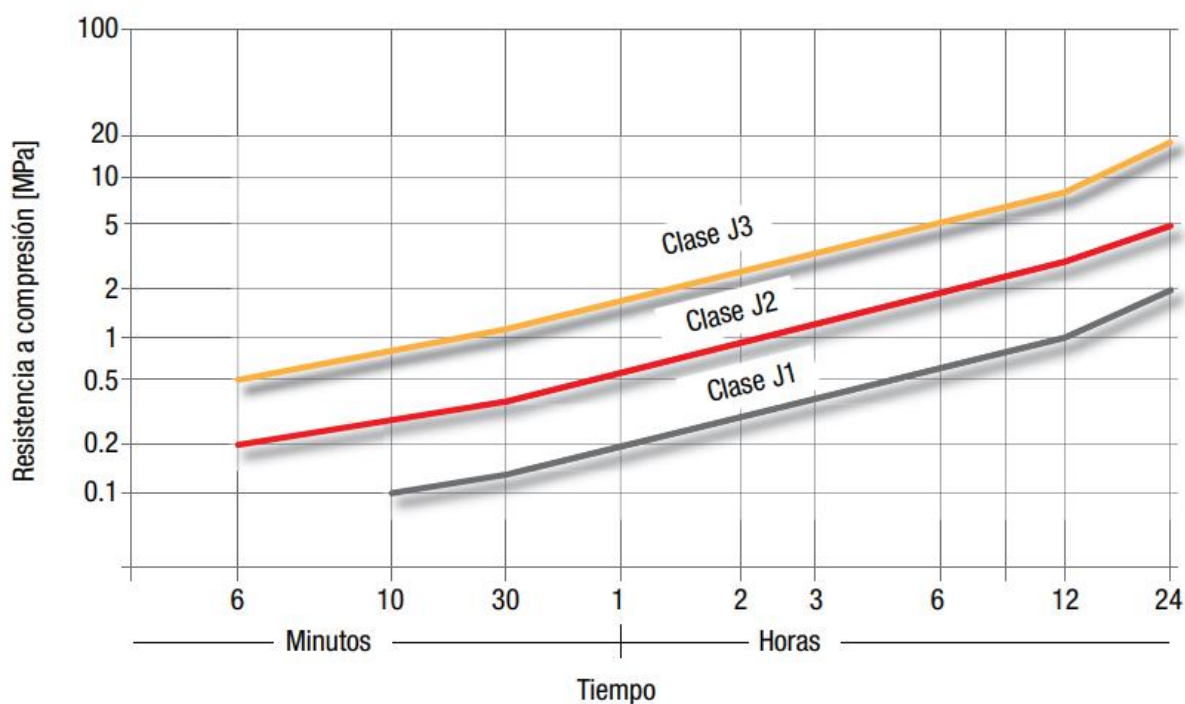
Figura 10. Clases de resistencia temprana del hormigón proyectado.
