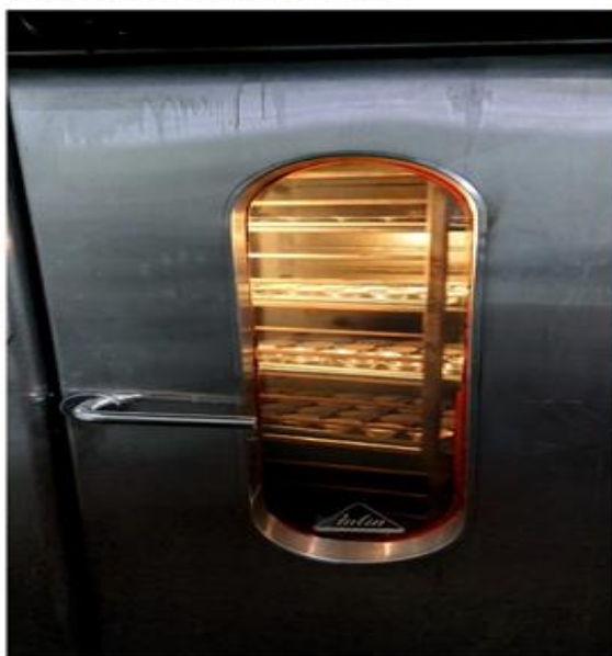
Foto 3: Horno rotativo empleado
