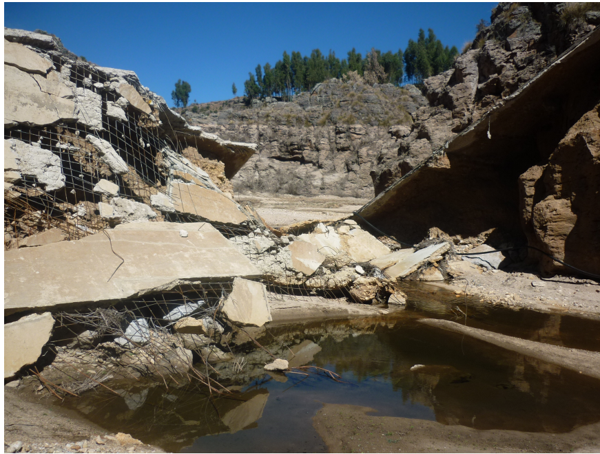
Figura A.2: Brecha formada por el rompimiento de la presa TOMACUCHO. Fuente: Elaboración propia.
