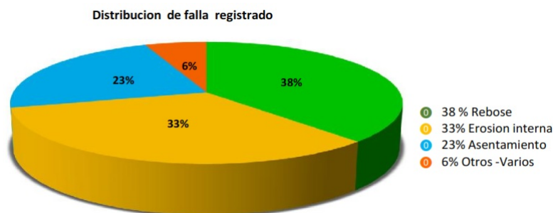
Figura 2.4: Falla registrados a nivel mundial por el ICOLD.
