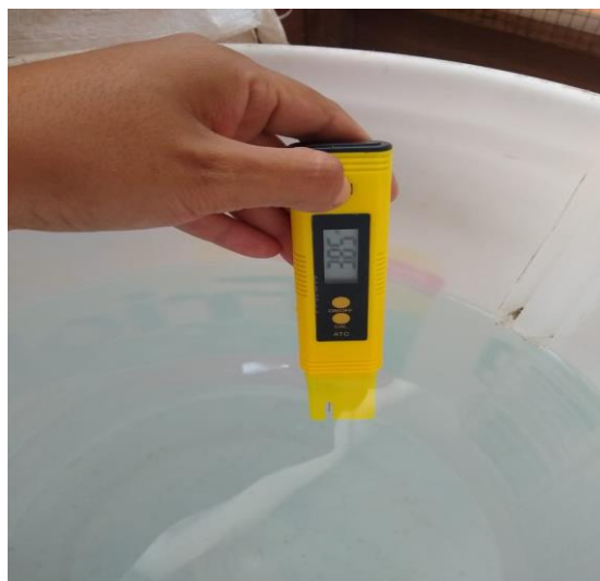
Foto 7. Medición del PH del agua
