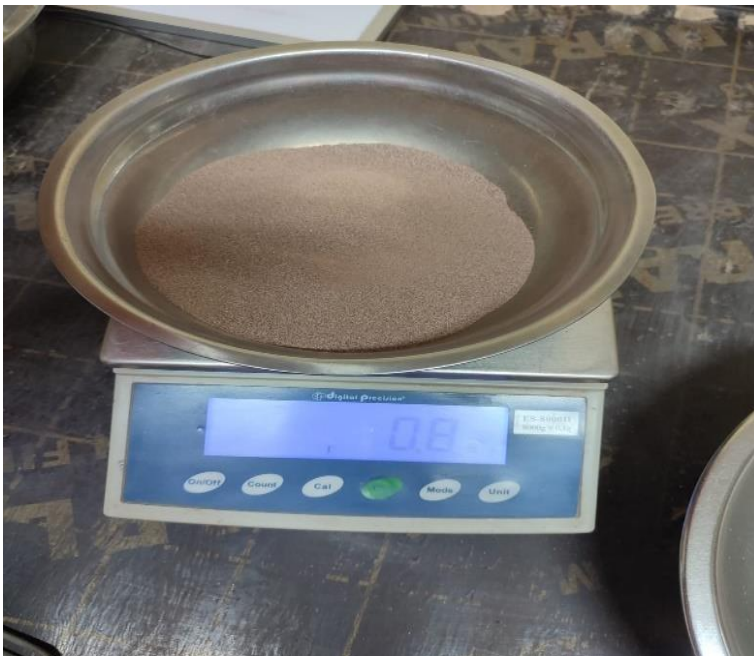
Figura 7: Pesaje de las muestras para clasificación granulométrica
