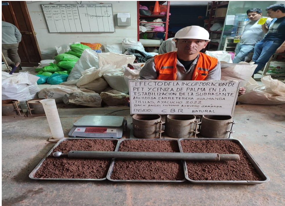
Ensayo de C.B.R.
