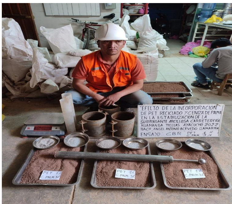
Figura 9: Ensayo de Proctor modificado
