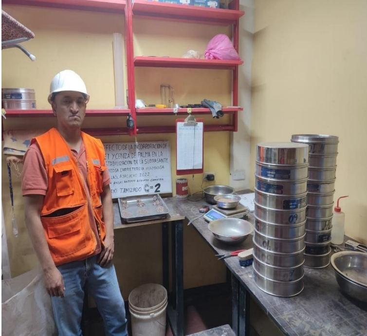
Figura 6: Tamizado de las muestras para clasificación granulométrica
