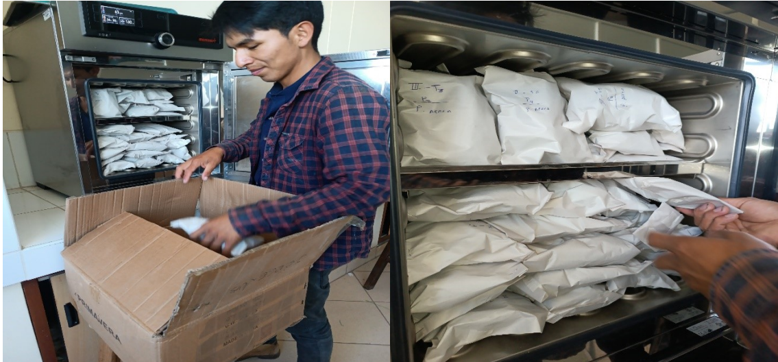
Lamina 19. El secado de las muestras en estufa.
