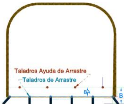
Figura 47 Diseño de taladros de arrastre Fuente: Manual de P & V - Lopez Jimeno
