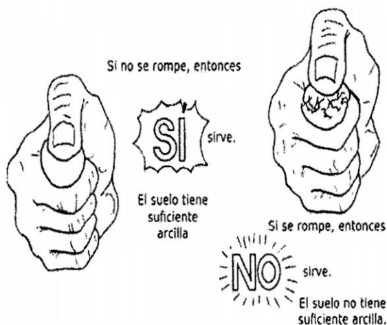
Figura 37. Prueba de la tierra para la construcción de adobes (Referencia: Cartilla Nuevas Casas Resistentes de Adobe PUCP/USAID-PERU/SENCICO)
