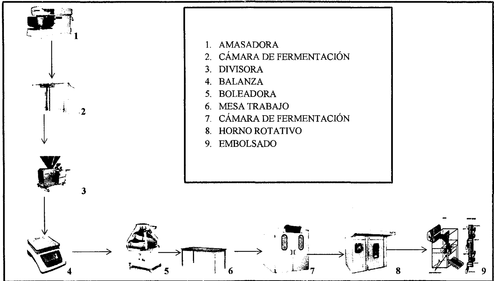
Figura 5.9: Secuencia de equipos en sala de proceso.
