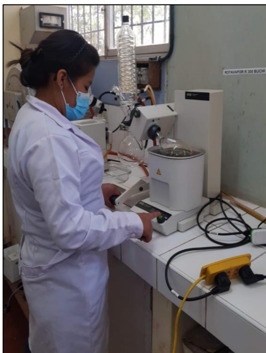
Rota vapor Buchi R-300 concentración a temperatura constante y presión reducida
