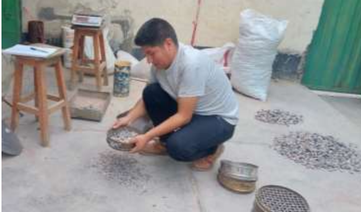
Ensayo de granulometría de agregado grueso
