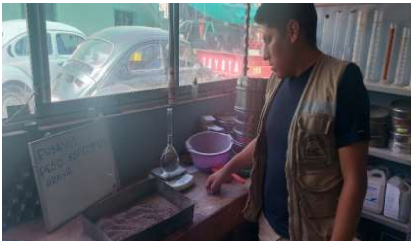
6.13. Vertido agregado a fiola
