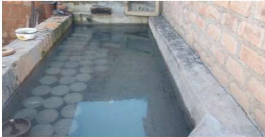
6.30. Curado de las probetas
