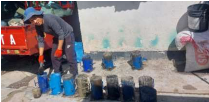
6.20. Enrasando los moldes para facilitar el desmolde
