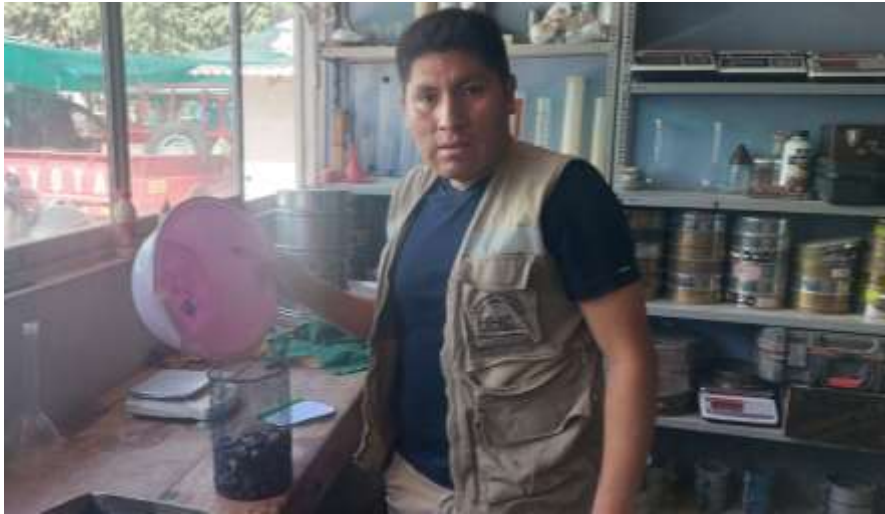
6.18. Vertido de agregado grueso al cesto
