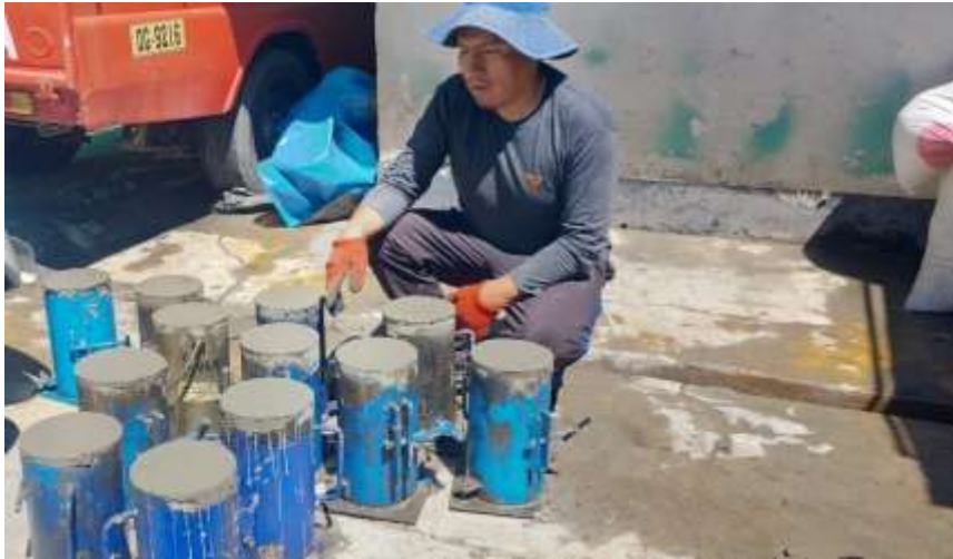
6.27. Acabado raleado de las probetas
