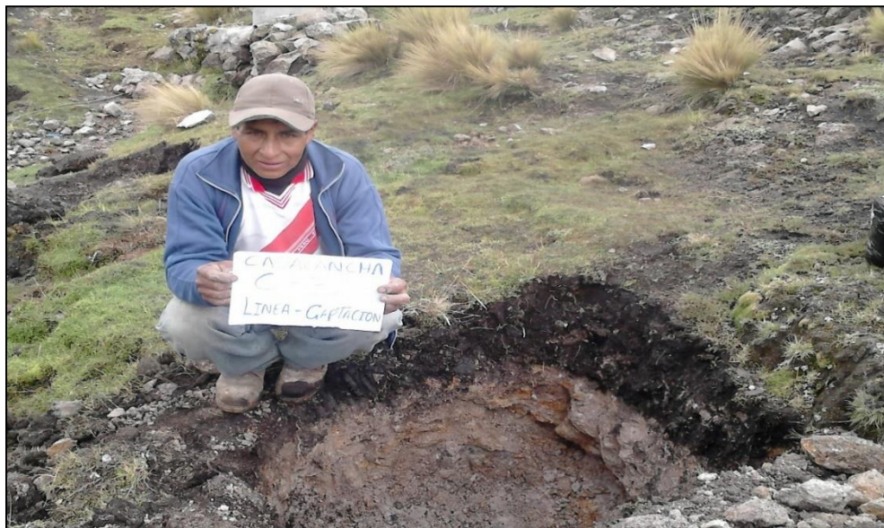
Figura 8. Calicata N° 24 en la captación, las cuales se tendrán resultados el perfil estratifico y la capacidad portante para la construcción hidráulica Fuente: Elaboración propia
